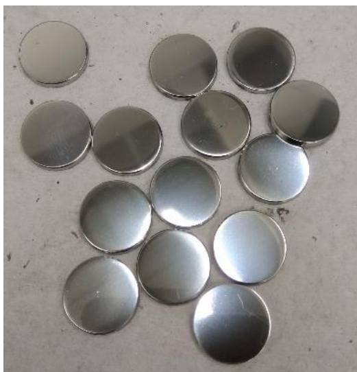
Rysunek 3.2. Przygotowane próbki o średnicy 25 mm ze stopu kobaltu stellite 6
