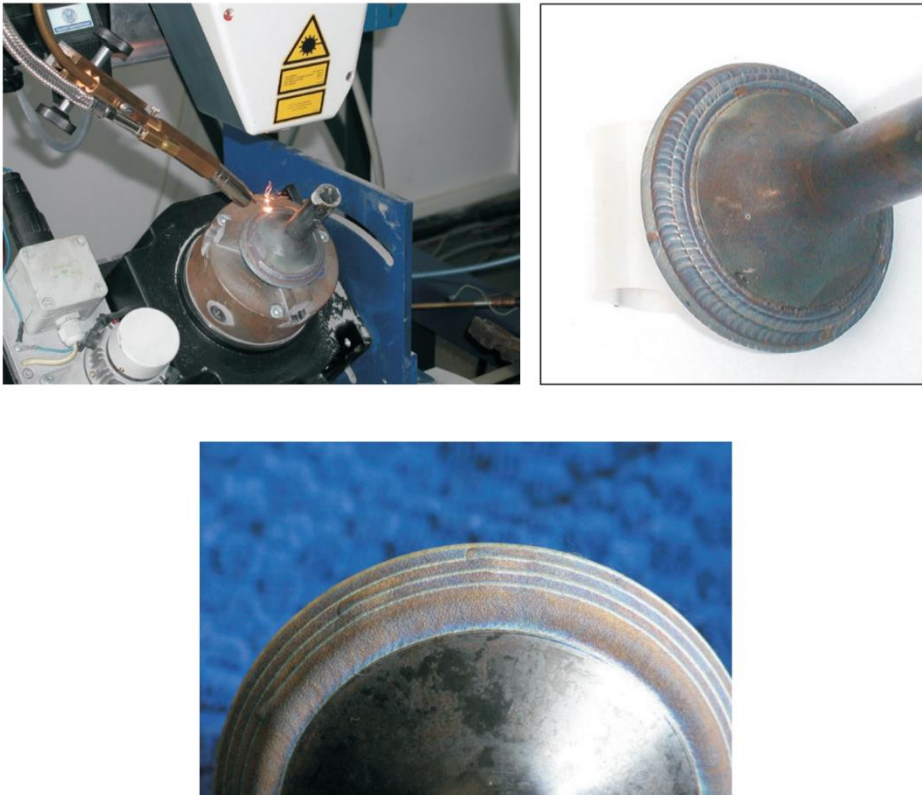
Rysunek 2.16. Przykład nakładania warstwy stellite na przylgnię grybka zaworowego metodą platerowania (napawania) [2]
