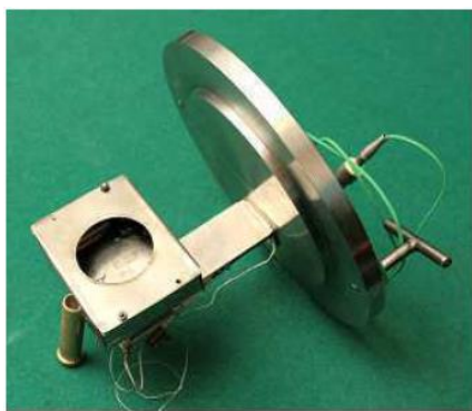
Rysunek 3.6. Pokrywa komory tarczowej implantatora UNIMAS 79 wyposażona w piecyk próżniowy [77]
