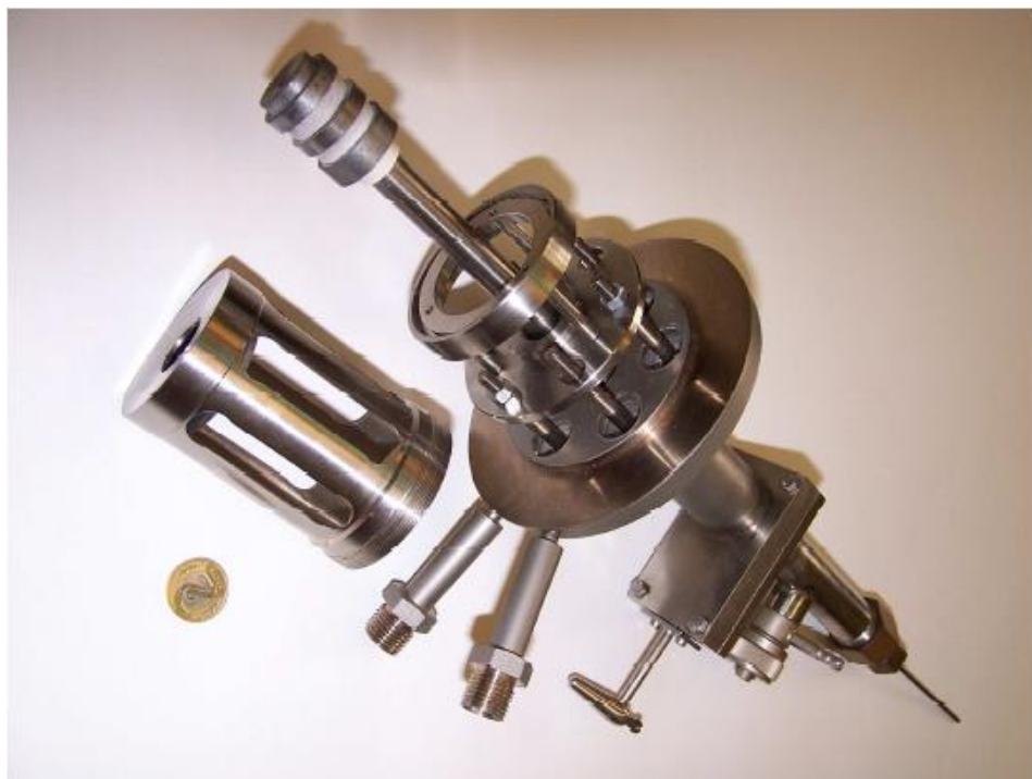
Rysunek 3.8. Plazmowe źródło jonów typu Nielsena stosowane w implantatorze UNIMAS 79
