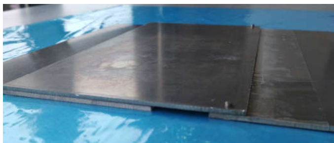
Rys. 3.18. Sposób złożenia klejonych paneli użytych w badaniach
