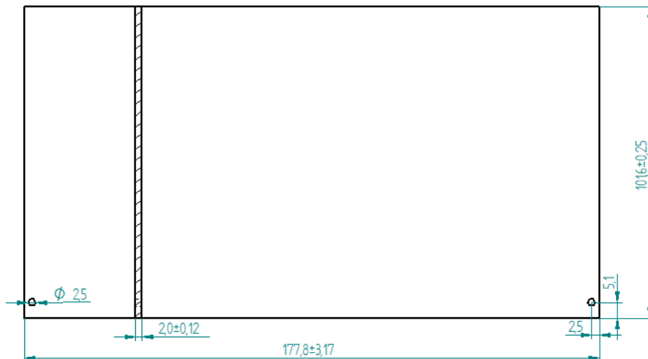
Rys. 3.17. Wycięty arkusz blachy EN AW 2024 T3 przeznaczony do klejenia
