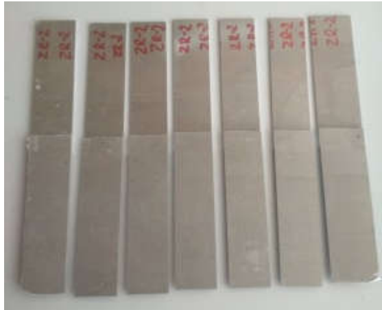
Rys. 3.23. Pojedyncze próbki połączeń klejowych wycięte z panelu
