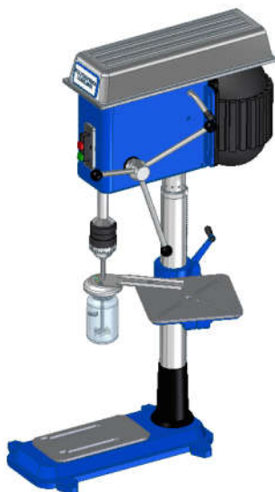
Rys. 3.8. Stanowisko do mieszania kompozycji klejowych
