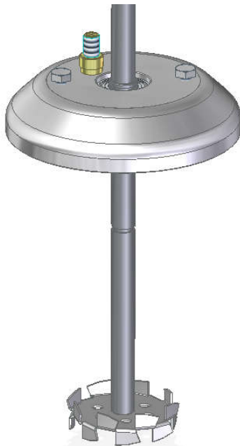
Rys. 3.7. Uchwyt umożliwiający mieszanie i jednoczesne odpowietrzanie kompozycji klejowych [65]
