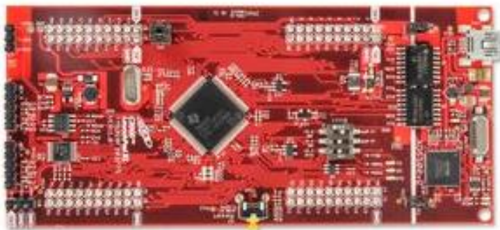
Rys. 9. Płytkę ewaluacyjną z mikrokontrolerem F28377S
