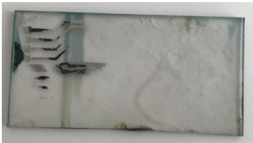
Rys. 8. Pierwsza próba przeprowadzenia fotolitografii na warstwie aluminium
