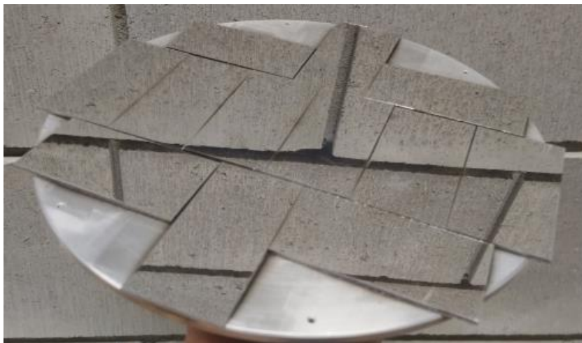
Rys. 5. Podłoża poliwęglanowe z osadzoną warstwą glinu
