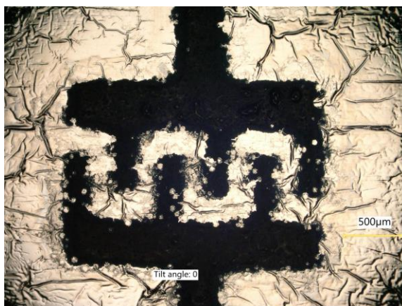
Rys. 11. Obraz pojedynczego kondensatora grzebieniowego z aluminium
