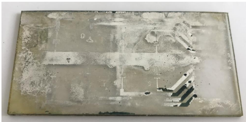
Rys. 9. Druga próba przeprowadzenia fotolitografii na warstwie aluminium
