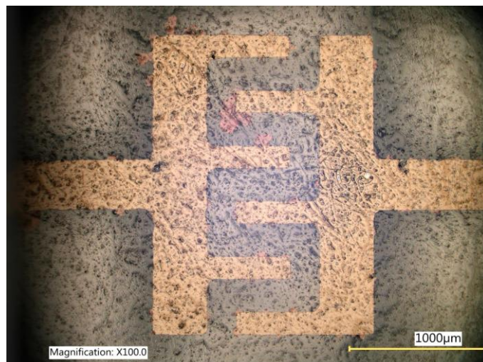
Rys. 16. Elektroda niklowa z widocznymi komórkami fibroblastów małych po przeprowadzeniu 85h hodowli
