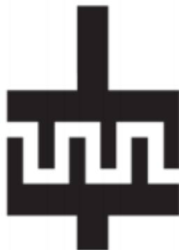
Rys. 4. Zaprojektowany kondensator grzebieniowy o minimalnych szerokościach ścieżek wynoszących 200 \mu\text{m}
