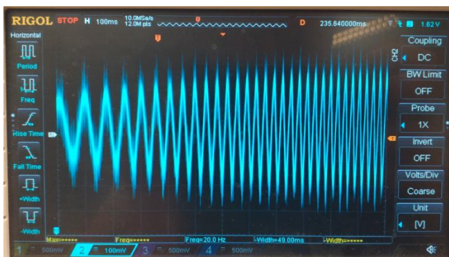
Rys. 13. Wyjściowy przebieg prądu przekształtnika
