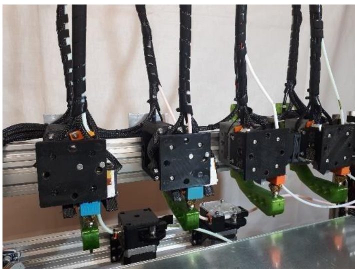
Rys. 3. Zadokowane głowice drukujące (dwie z lewej typu Bowden oraz dwie z prawej typu direct)
