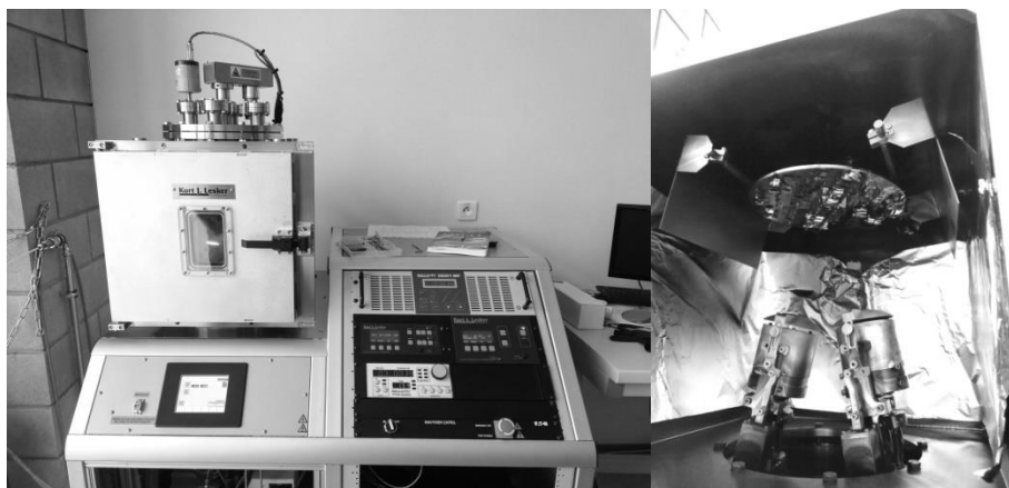
Rys. 10. Napylarka NANO 36™ Kurt J. Lesker® (po lewej), komora napyłania (po prawej)
