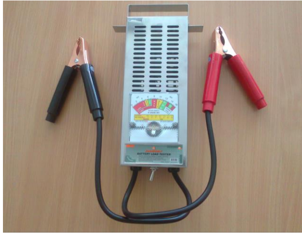
Rys. 3.3. Zdjęcie testera akumulatora AR020014 R150 firmy Jonnesway [23]
