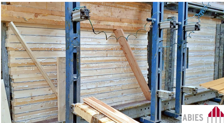
Rys. 6.2. ABIES Polska Sp. z o.o. – proces klejenia belek i stanowisko
