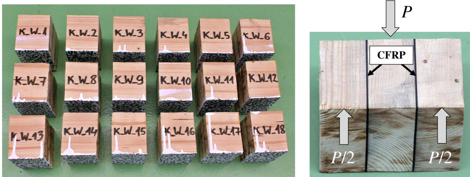
Rys. 5.20. Próbkki „KW” do badań połączenia drewno-CFRP
