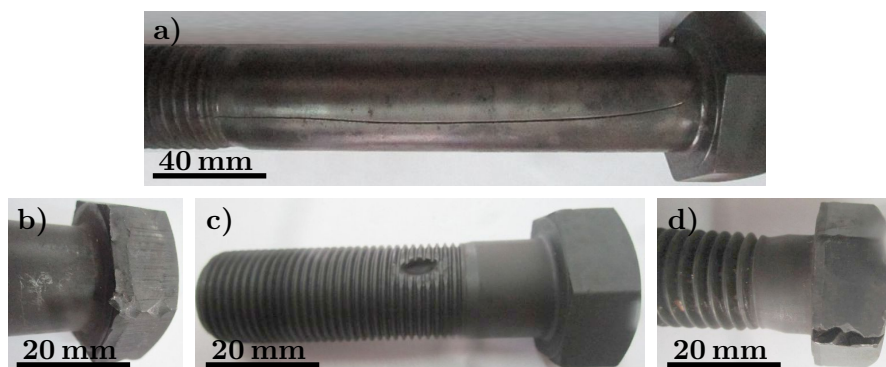
Rys. 2.2. Przykłady wad śrub z gwintem calowym wykonanym na części długości trzpienia: a) 1\frac{3}{4}'' ; b) – d) \frac{7}{8}''
