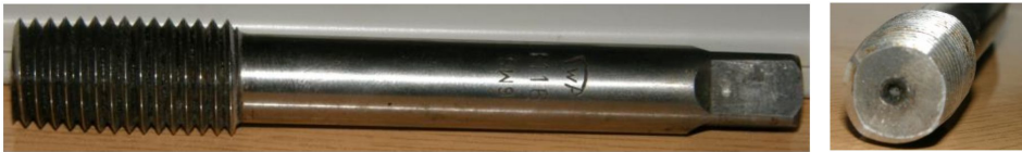
Rys. 1.26. Gwintownik nagniatający M16 kształtujący gwint o parametrach zarysu zbliżonych do gwintu wykonanego w procesie walcowania
