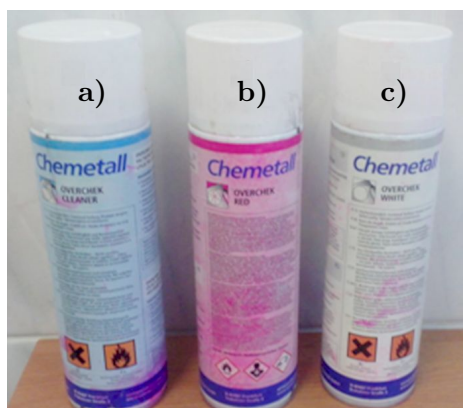
Rys. 2.5. Preparaty w postaci sprayów, wykorzystywane do prowadzenia badań penetracyjnych: a) zmywacz, b) penetrant o barwie czerwonej, c) wywoływacz o barwie białej
