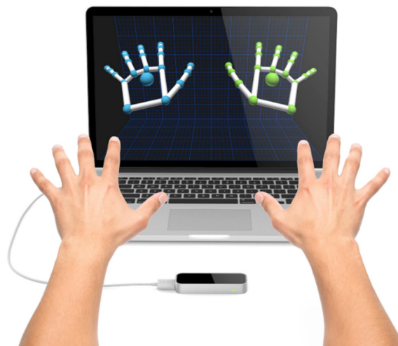
Rysunek 6: Przykład aplikacji ukazująca model dłoni odczytany przez kontroler Leap Motion [6].
