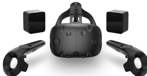
Rysunek 4: Gogle HTC Vive z kontrolerami oraz dwiema stacjami bazowymi [10].
