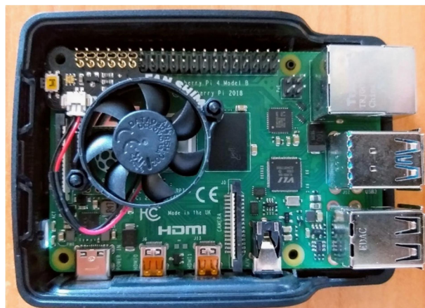
Rysunek 7: Mikrokomputer Raspberry Pi 4B z zamontowanym wentylatorem.
