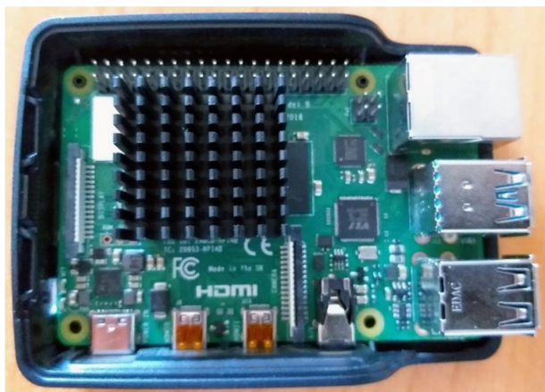
Rysunek 5: Mikrokomputer Raspberry Pi 4B wyposażony w radiator.
