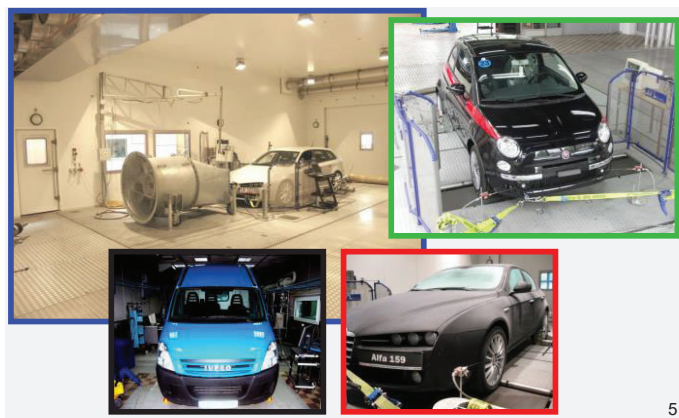
Rys. 37. Badania homologacyjne na hamowni podwoziowej; wewnątrz komory klimatycznej z wentylatorem chłodzącym samochód oraz pozostałe badania emisyjne [14]
