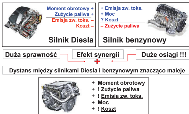
Rys. 13. Zbliżenie konstrukcyjne silników o zapłonie iskrowym i samoczynnym
