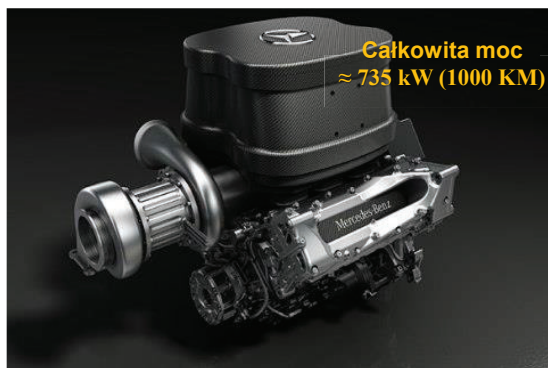
Rys. 33. Benzynowy silnik hybrydowy zastosowany w Formule 1
