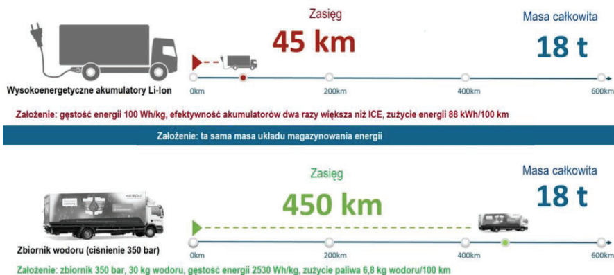
Rys. 31. Porównanie zasięgu pojazdu elektrycznego i pojazdu z silnikiem spalinowym, zasilanego wodorem, przy założeniu tej samej masy układu magazynującego energię (około 420 kg)
