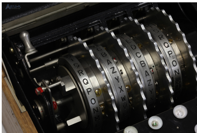
Rysunek 3. Wirniki Enigmy (źródło: Wikipedia)
