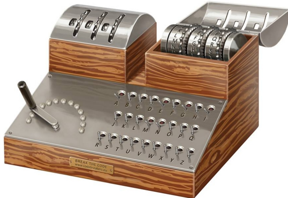
Rysunek 7. Cyklometr (źródło: https://enigma.umww.pl/ )
