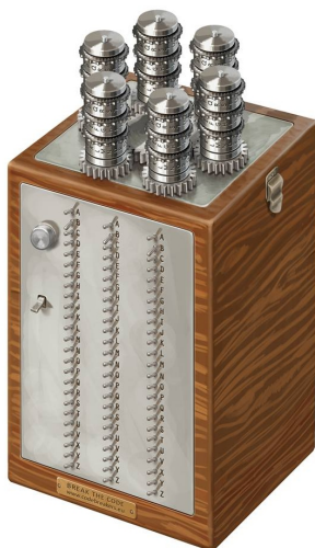
Rysunek 10. Bomba Rejewskiego (źródło: enigma.umww.pl)
