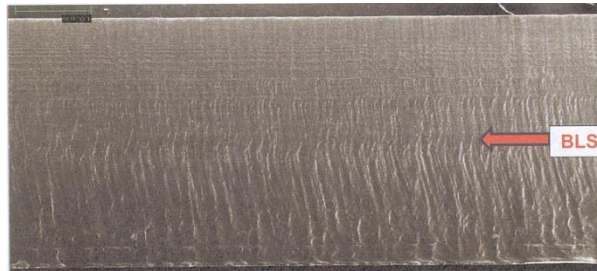
Rys. 2.4. Widok skaningowy powierzchni cięcia blachy ze stali austenitycznej ANSI 308 o grubości 8 mm z wyraźną linią rozdziału powierzchni (BLS) (parametry cięcia: moc wiązki 4 kW, prędkość cięcia 1 m/min, gaz - azot o ciśnieniu 0,48 MPa) [63]
