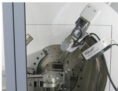
Rys. 3.4. Wysokorozdzielczy dyfraktometr rentgenowski Empyrean: a) widok ogólny, b) układ pomiarowy
