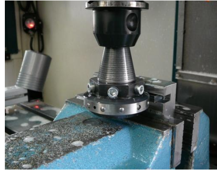
Rys. 3.10. Schemat procesu nagniatania na pionowym centrum obróbkowym (1 – próbka, 2 – uchwyt, 3 – imadło, 4 – głowica nagniatająca): a) kinematyka nagniatania, b) widok stanowiska
