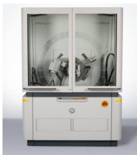
Rys. 3.4. Wysokorozdzielczy dyfraktometr rentgenowski Empyrean: a) widok ogólny, b) układ pomiarowy
