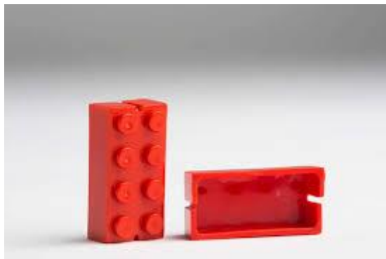
Rys. 2. Przykład klocków wydrukowanych z ABS
