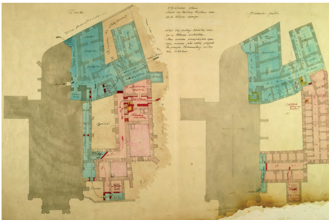
Il. 255. Rzut parteru i piętra klasztoru Bernardynów 1865 r., projekt podziału (na niebiesko część przeznaczona na siedzibę nowej parafii, na różowo część przeznaczona na koszary), AGAD, Zb. Kart. 17–25 ark. 6
