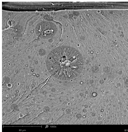
Rys. 5.10. Kratery jako pozostałości po domenach kauczuku o większych rozmiarach
