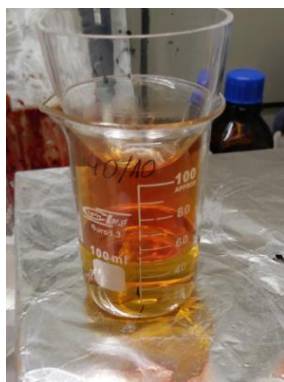
Rys. 5. Utlenianie chemiczne podłoży GaAs
