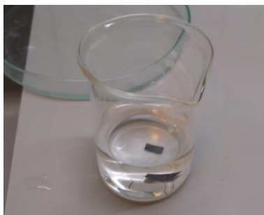
Rys. 4. Kąpiel w amoniaku przed procesem utleniania chemicznego
