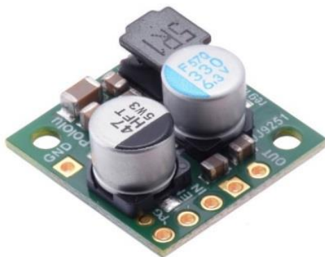
Rys. 2. Impulsowa przetwornica napięcia Pololu D24V22F5 [7]
