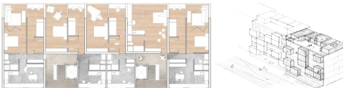
Ryc. 5. Plan budynku w technologii OWT-67 z wprowadzeniem nadbudowy i dźwigów osobowych. Praca studencka.
