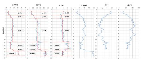
Fig. 3. CPT-1 test parameters
