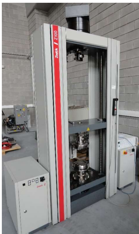
Rys. 4.4. Statyczna maszyna wytrzymałościowa Zwick–100
