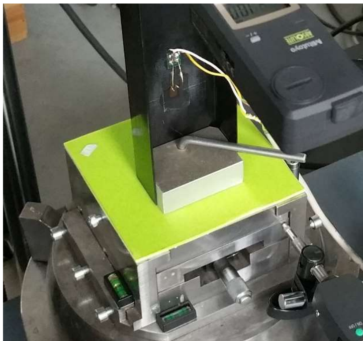
Rys. 4.5. Realizacja podparcia przekroju końcowego próbki badawczej
