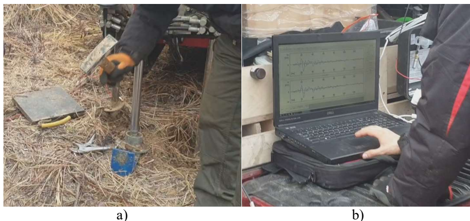
Fot. 4.5 Test dylatometrem sejsmicznym SDMT (badania własne lessów Lublina opisane w rozdziale 3 – lokalizacja Lublin, ul. Jutrzenki): a) wywoływanie fali poprzecznej, b) rejestracja fali zestawem pomiarowym
