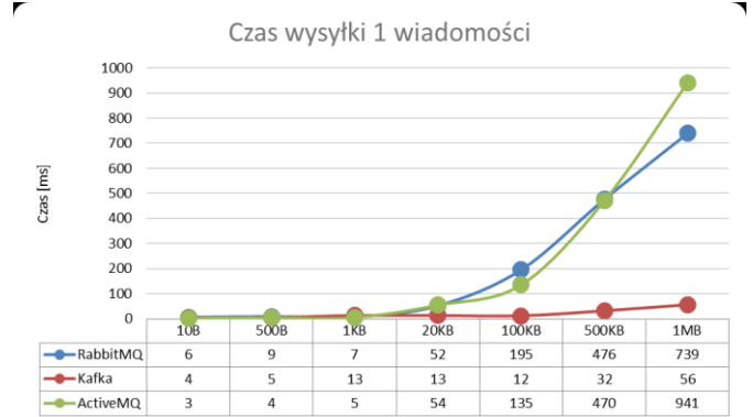
Rys. 1. Czas przesłania pojedynczej wiadomości o różnym rozmiarze za pomocą każdej z kolejek.
