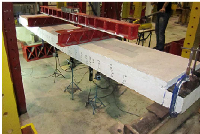
Rys. 2.26. Przykład badanej płyty zespolonej z warstwą nadbetonu (Mansour i in., 2015)
