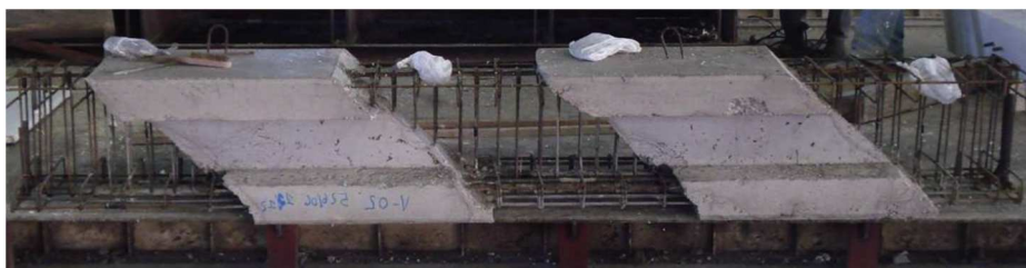
Rys. 2.31. Widok belki przygotowanej do zespolenia z ukośną przerwą roboczą (Cavaco, 2018)
