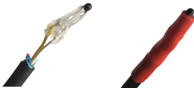
Rys. 14. Termistor NTC 10 k \Omega przygotowany do pracy w czynniku wytrawiającym
