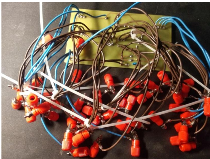
Rys. 5. Widok stanowiska po przylutowaniu żeńskich gniazd bananowych
