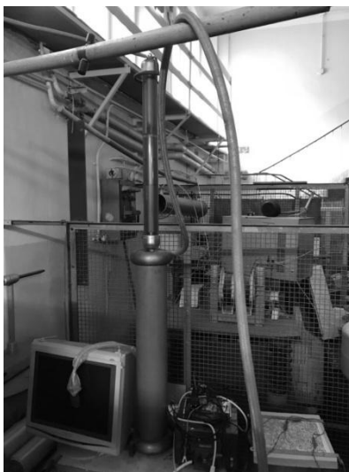
Rys. 10. Prostownik wysokiego napięcia zasilający stanowisko
