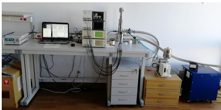
Rys. 1. Stanowisko pomiarowe do badań właściwości elektrycznych nanokompozytu (\text{FeCoZr})_x(\text{SiO}_2)_{(100-x)}
