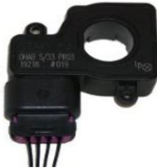
Rys.7. Czujnik z efektem Hall firmy Orion BMS[5]
