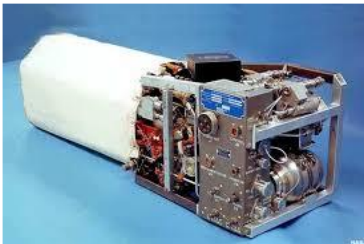
Rys. 2. Ogniwo paliwowe typu AFC wykorzystane w promie kosmicznym[2]
