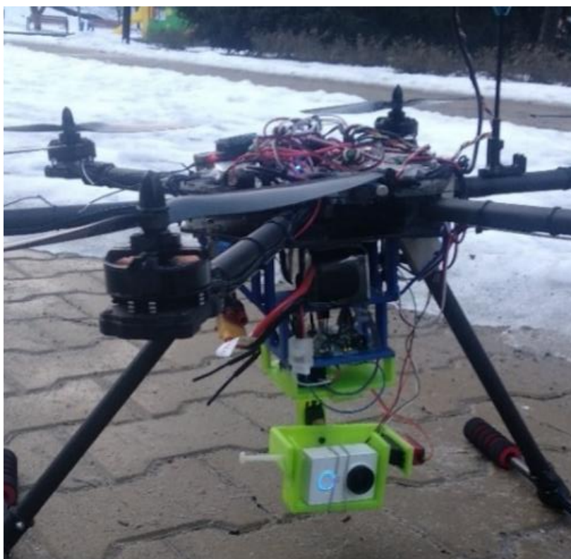
Rys. 11. Gotowy stabilizator zamontowany do drona
