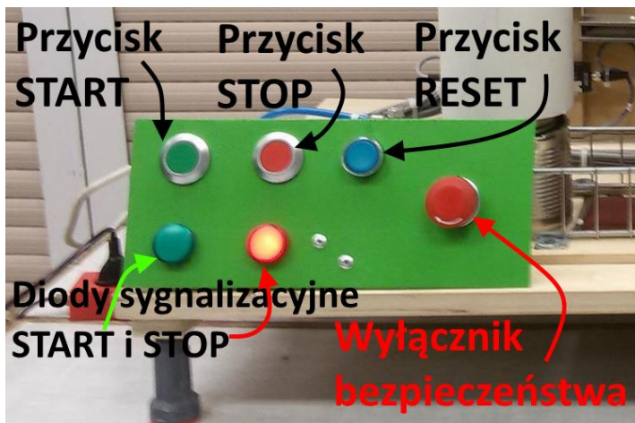
Rys. 8. Opis panelu operatorskiego
