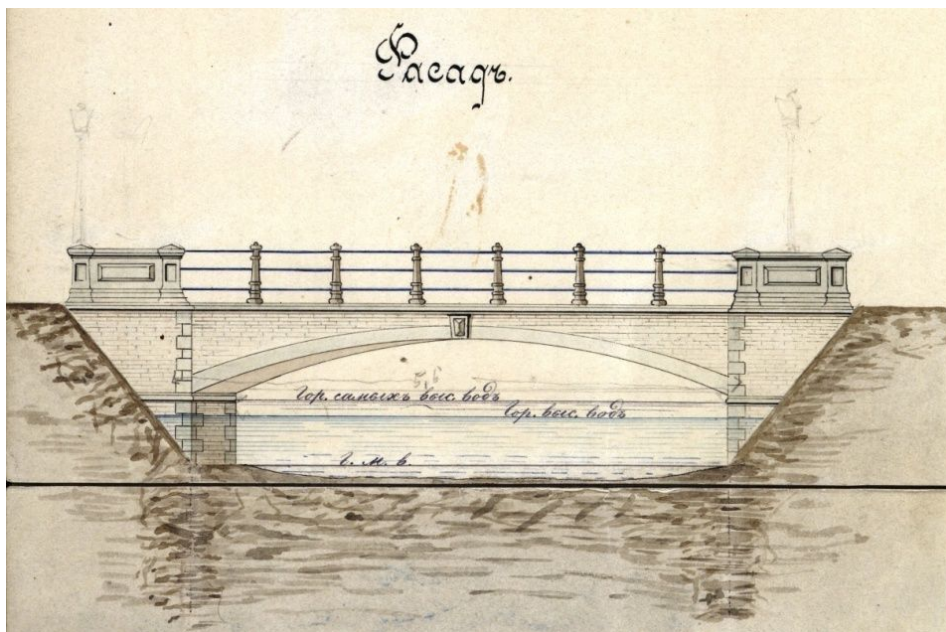
Rys. 50. Widok z boku mostu w systemie „Monier’a” przez rz. Czechówkę w Lublinie, wg [63]
