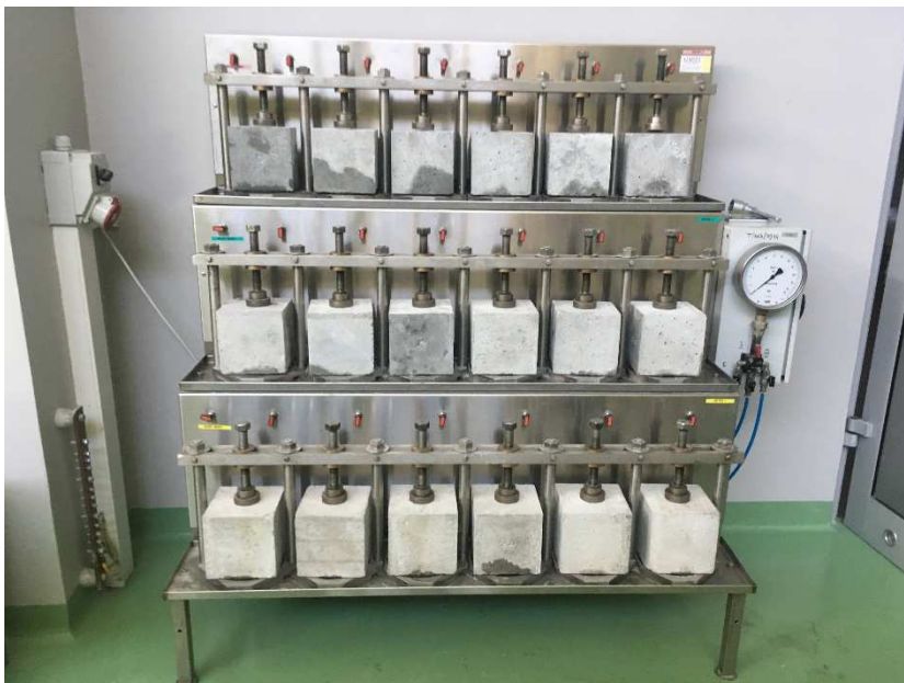
Rys. 6.20. Widok próbek w trakcie badania odporności na penetrację wody pod ciśnieniem
