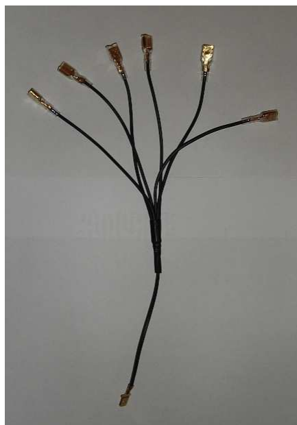
Rys. 7.7. Rozdzielacz przewodu masowego czujników
