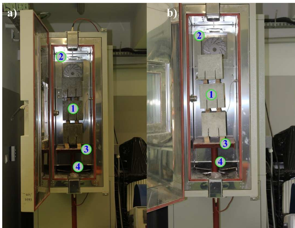
Rys. 7.38. Widok kostek w komorze w 2 stanach wilgotnościowych, przed procedurą wymrażania: a) próbki nasycone wodą, b) próbki powietrzno-suche; 1 – kostka, 2 – komora termiczna, 3 – podkładki drewniane, 4 – stojak do podtrzymywania próbek
