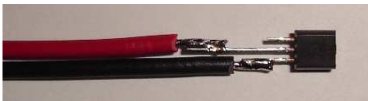
Rys. 7.5. Etap przygotowania czujników do umieszczenia w próbce – lutowanie przewodów
