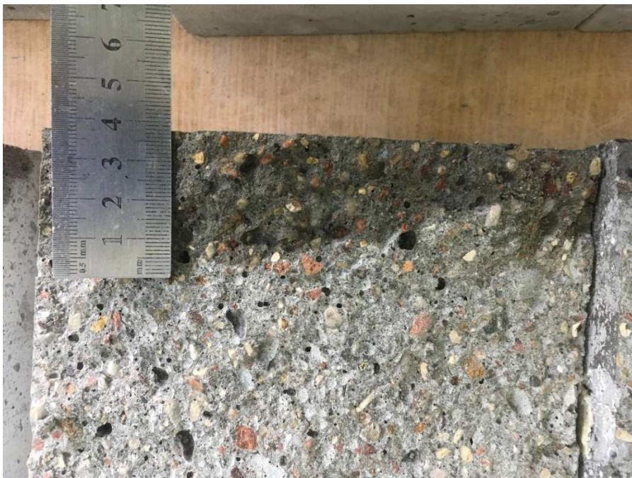
Rys. 6.22. Przykładowy pomiar zasięgu penetracji wody pod ciśnieniem w próbce
