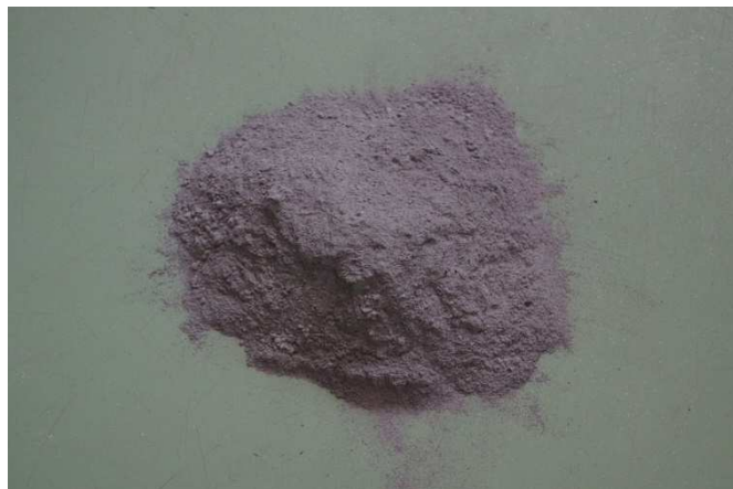
Rys. 6.4. Widok zastosowanego popiołu lotnego krzemionkowego
