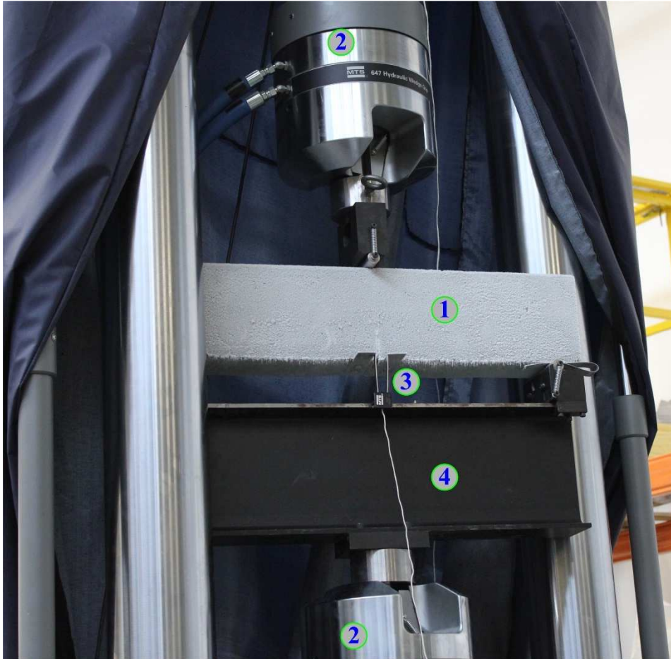
Rys. 7.31. Widok belki podczas badania: 1 – belka, 2 – prasa, 3 – ekstensometr nasadowy do pomiaru CMOD, 4 – układ wsporczy
