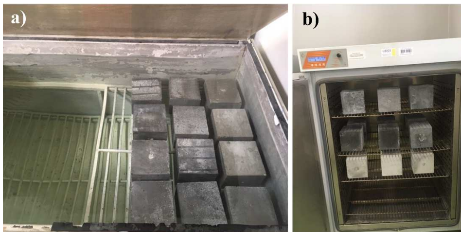
Rys. 6.16. Etapy badania nasiąkliwości betonów: a) nasączenie próbek wodą w wannie, b) suszenie próbek do stałej masy w suszarce z termoobiegiem
