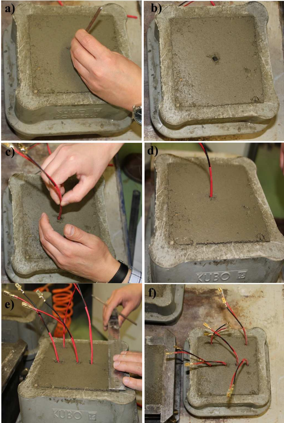
Rys. 7.8. Etapy rozmieszczenia czujników w próbce modelowej (opis w tekście)
