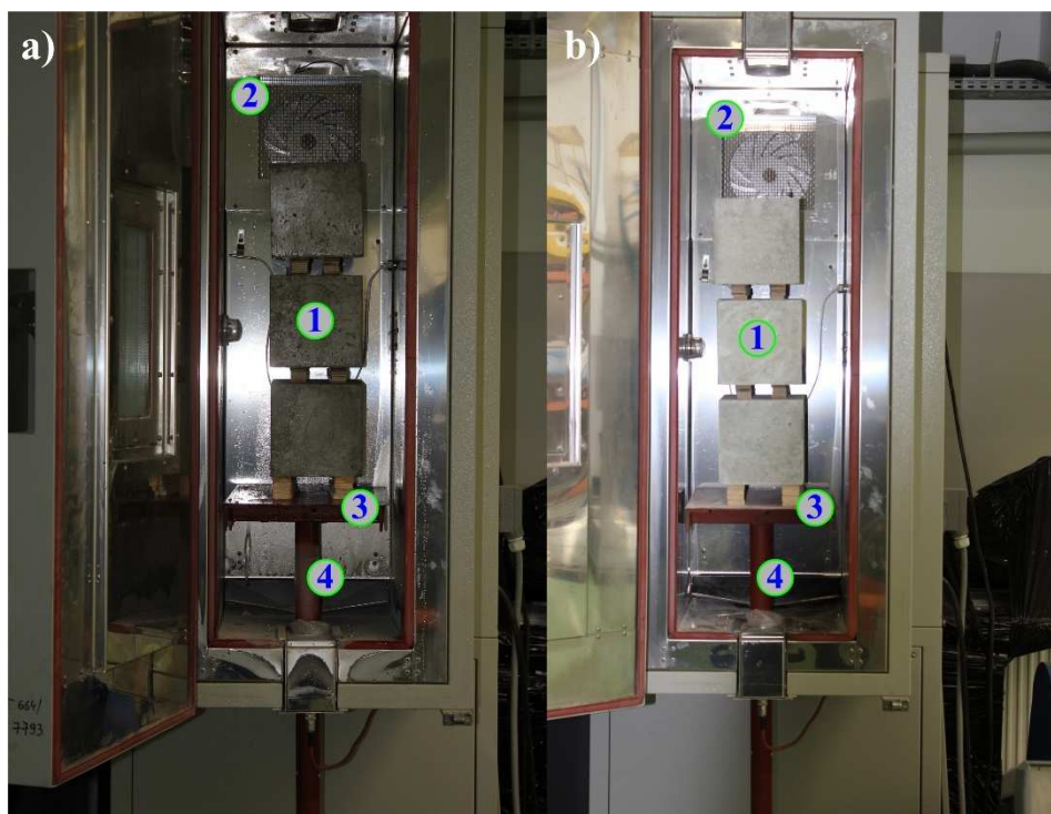
Rys. 7.17. Widok kostek w komorze, w 2 stanach wilgotnościowych, przed procedurą wymrażania: a) próbki nasycone wodą, b) próbki powietrzno-suche; 1 – próbka, 2 – komora termiczna, 3 – podkładki drewniane, 4 – stojak do podpierania próbek
