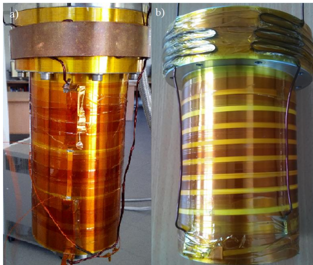
Rys. 3. Laboratoryjne modele nadprzewodnikowych ograniczników prądu zwarciego typu rezystancyjnego a) SFCL – 1, b) SFCL – 2
