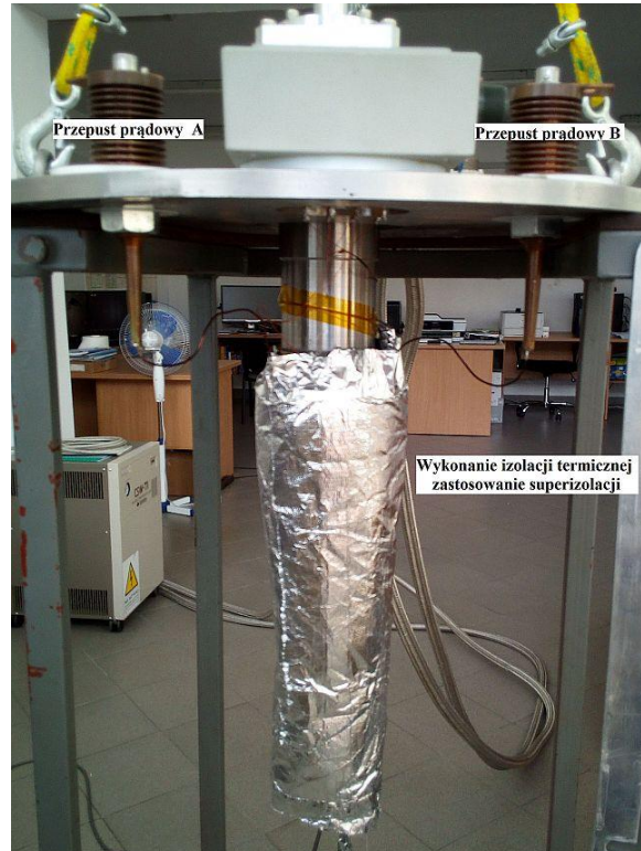
Rys. 7. Wykonanie izolacji termicznej SFCL poprzez zastosowanie superizolacji
