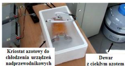
Rys. 8. Przykładowy kriostat do chłodzenia urządzeń nadprzewodnikowych i dewar z ciekłym azotem
