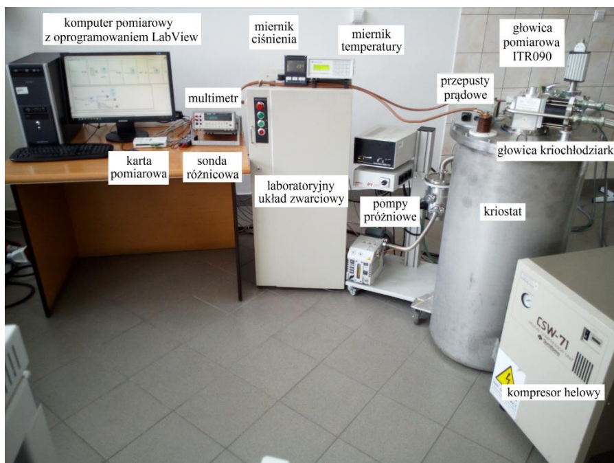
Rys. 4. Stanowisko pomiarowe do badania nadprzewodnikowych ograniczników prądu zwarciovego
