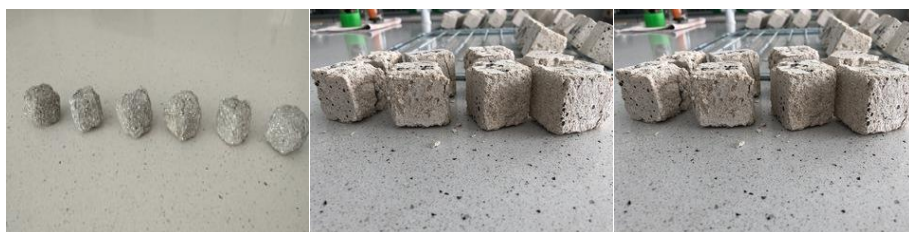
Rys. 2. Wygląd próbek po badaniu odporności na ciśnienie krystalizacyjne soli. Od lewej zaprawy: Z, Na-P1, Na-X
