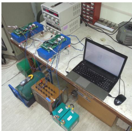
Rys. 7. Stanowisko testowe do badań przetwornic DC/DC
