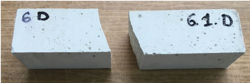
Fot. 49 Widok próbki po badaniu wytrzymałości na zginanie
