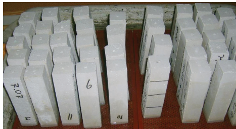
Fot. 53 Oznaczenie współczynnika nasiąkliwości kapilarnej dla zapraw wapiennych – początek badania
