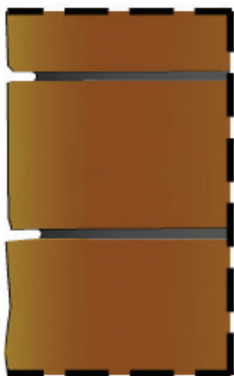
Rys. 14 Korozja solna powierzchni muru przy zaprawie słabszej niż materiał murowy
