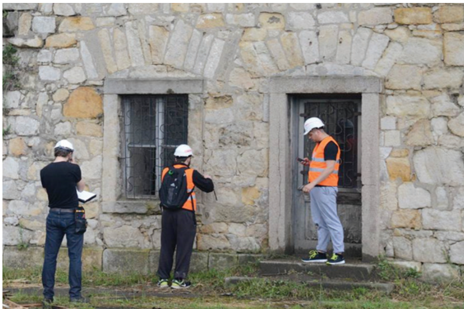
Fot. 1 Pomiary tradycyjne elewacji Donżonu Twierdzy Kłodzko
