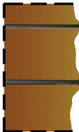
Rys. 15 Korozja solna powierzchni muru przy zaprawie mocniejszej niż materiał murowy
