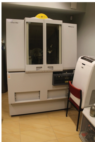
Fot. 59 Dyfraktometr rentgenowski – X'pert PRO MPD firmy Panalytical
