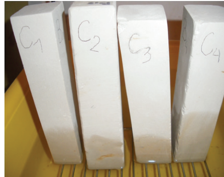
Fot. 52 Oznaczenie współczynnika nasiąkliwości kapilarnej dla opoki wapińskiej – koniec badania
