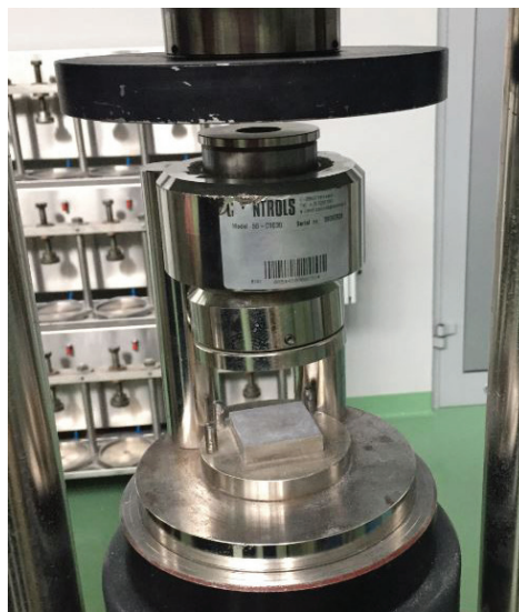
Fot. 44 Maszyna wytrzymałościowa z nadstawką do badania
