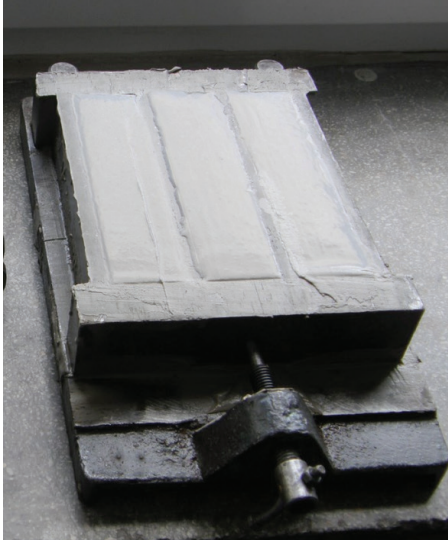
Fot. 47 Formowanie próbek zapraw
