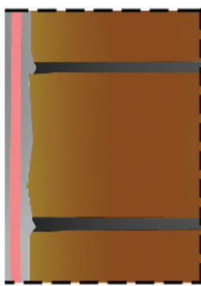
Rys. 17 Korozja solna wewnątrz warstwy tynku
