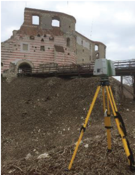
Fot. 4 Skaner Leica C10 podczas prac terenowych na Zamku w Janowcu
