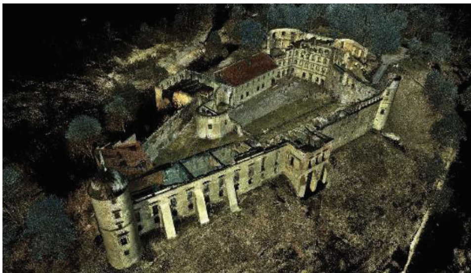
Rys. 3 Chmura punktów powstała w wyniku opracowania danych przestrzennych pozyskanych ze skanera Leica C10
