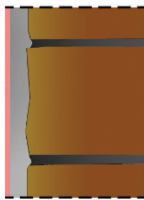
Rys. 18 Korozja solna na powierzchni tynku
