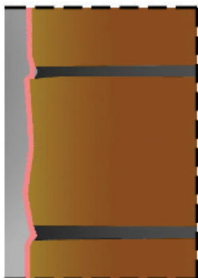
Rys. 16 Korozja solna na styku tynku i muru
