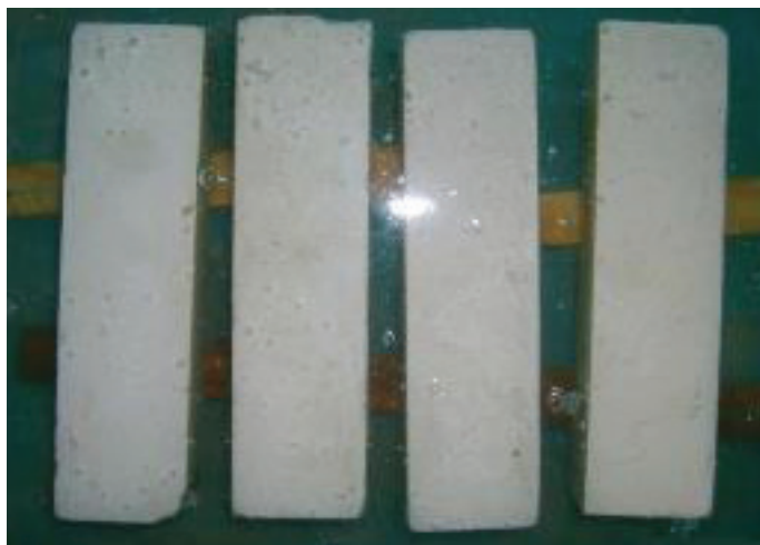
Fot. 50 Badanie nasiąkliwości kapilarnej
