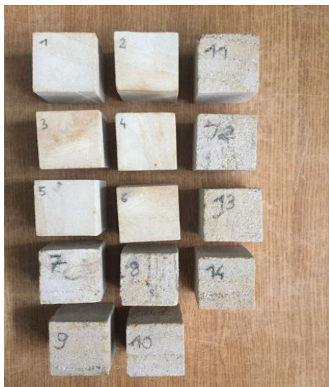
Fot. 43 Próbkki piaskowca przygotowane do badania wytrzymałości na ściskanie
