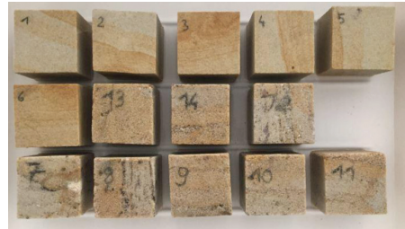
Fot. 54 Oznaczenie współczynnika nasiąkliwości kapilarnej dla piaskowca – początek badania
