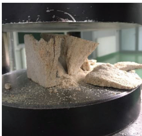
Fot. 46 Widok zniszczonej próbki po zakończeniu badania
