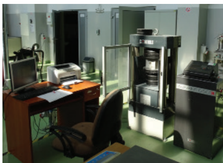
Fot. 42 Stanowiska badawcze – prasa hydrauliczna Controls Advantest 9
