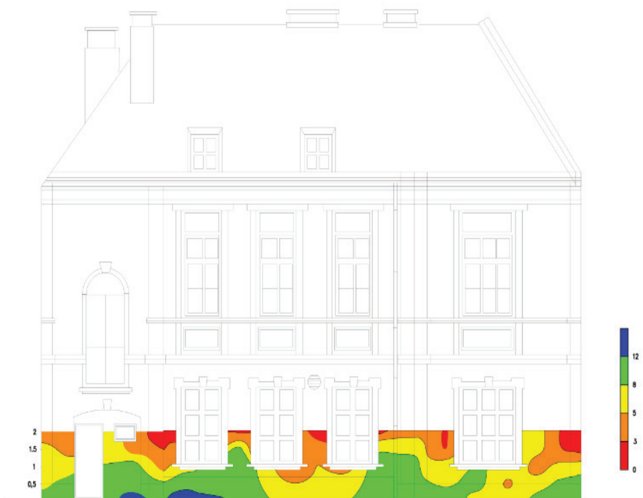
Rys. 4.16. Mapa zawilgocenia elewacji północnej
