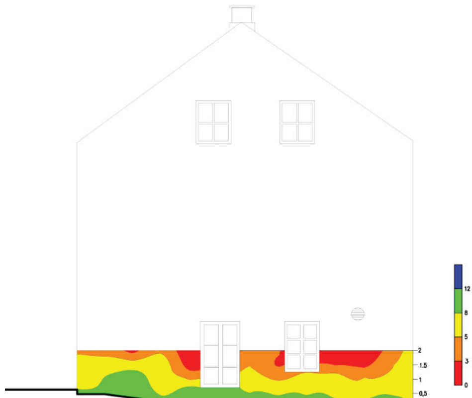
Rys. 4.17. Mapa zawilgocenia elewacji
