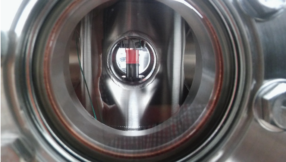
Rys. 2.10. Ilustracja termoemisyjnego źródła elektronów na stanowisku badawczym w Katedrze Automatyki i Metrologii Politechniki Lubelskiej (Fot. D. Kuś)
