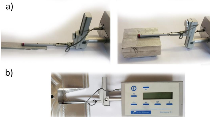
Rys. 2.20. Ustawienie końcówki do pomiaru: a) powierzchni poziomych, b) powierzchni pionowych
