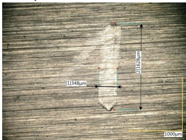
Rys. 3.16. Wada powierzchniowa na powierzchni po szlifowaniu
