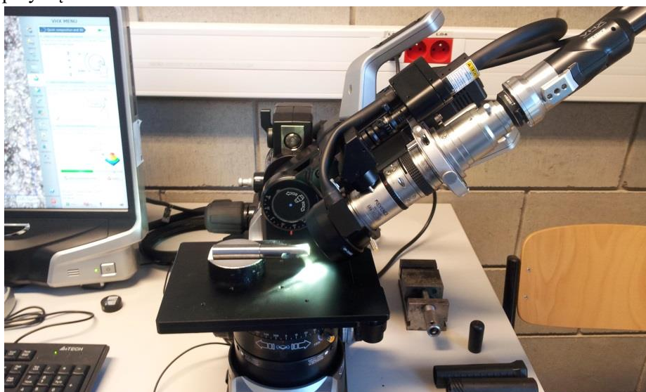
Rys. 3.6. Widok mikroskopu z pochylonym statywem do obserwacji wielokątowej
