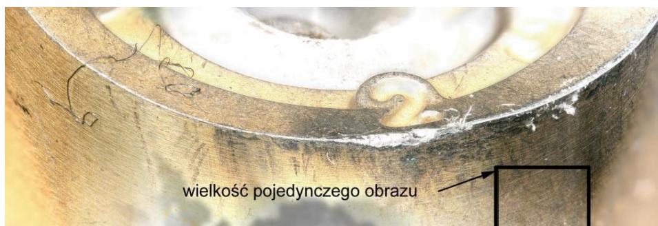
Rys. 3.7. Widok płytki skrawającej wykonany techniką łączenia obrazu
