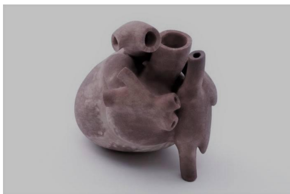
Rys. 5 Wydruk wykonany metodą CJP [9]
