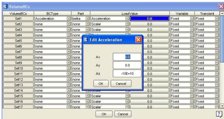
Rys. 9. Przykładanie przyspieszenia do elementu belka
