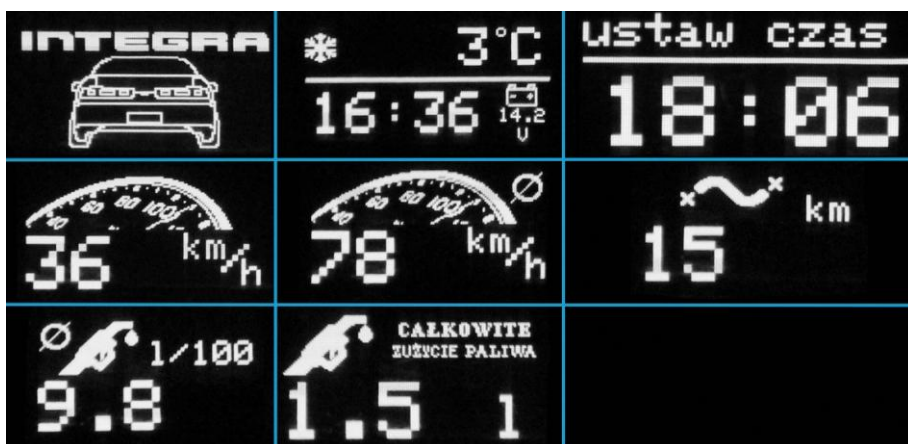
Rys. 11. Prezentacja funkcji projektu. Od lewej: Ekran startowy; Prezentacja godziny, temperatury oraz napięcia akumulatora; Konfiguracja zegara; Prezentacja prędkości chwilowej; Prędkość średnia; przejechany dystans; średnie spalanie; całkowite zużycie paliwa przy przejechanym dystansie
