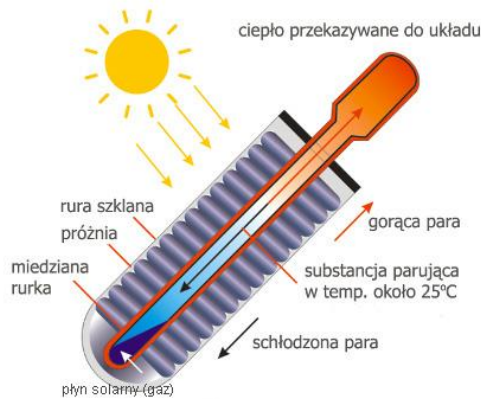
Rys. 2. Budowa i zasada działania kolektora próżniowego (heat pipe) [3]
