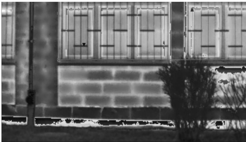
Rys. 2. Fotografia wykonana w trybie fuzji termowizji i obrazu cyfrowego – skala temperatury odpowiada jasności obrazu, tryb ten jest pomocny przy szacowaniu wpływu nieodpowiedniej emisyjności powierzchni na wyniki analizy obrazu termowizyjnego
