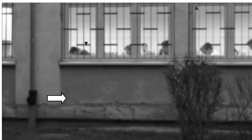
Rys. 1. Obraz cyfrowy obiektu z zaznaczonymi miejscami pomiaru punktowego wskazuje niekorzystne warunki wykonania pomiaru: widoczna przegroda naturalna (krzew), zbyt wysoka refleksyjność powierzchni oszklonej, tymczasowe źródła ciepła (ludzie, oświetlenie)
