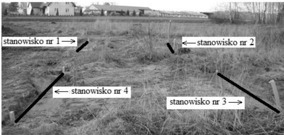
Fot. 7.4. Wyprowadzone na powierzchnię terenu oraz zaślepione końcówki rur badawczych na poszczególnych stanowiskach
