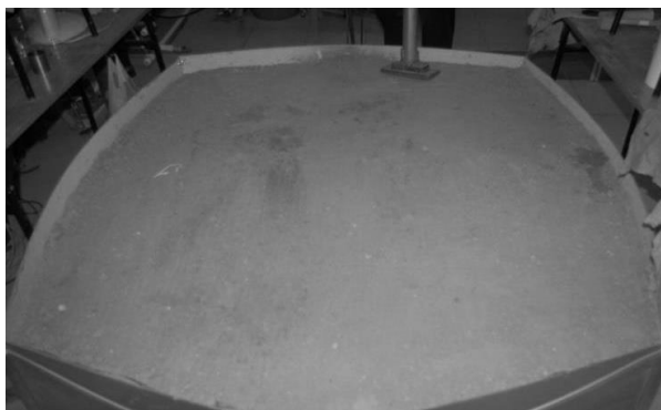
Fot. 4.2. Skrzynia przygotowana do przeprowadzenia fizycznej symulacji awarii wodociągu
