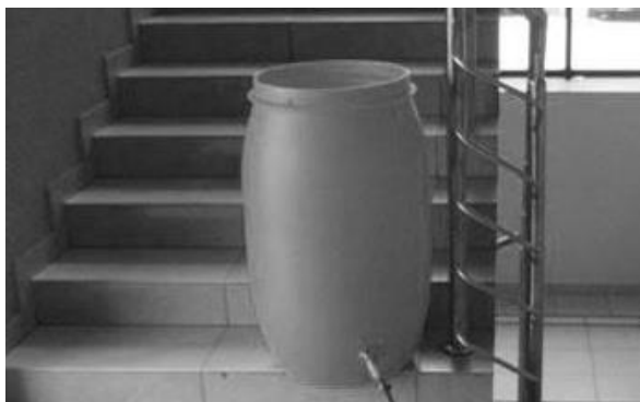
Fot. 4.3. Zbiornik zasilający
