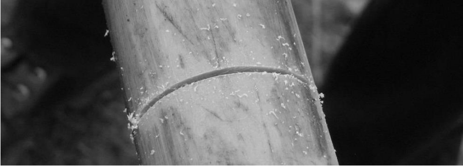
Fot. 7.1. Szczelina powstała po przecięciu rury badawczej
