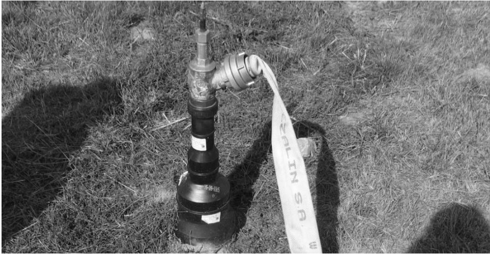
Fot. 7.8. Końcówka przewodu badawczego z zaworem odcinającym i podłączonym przewodem zasilającym
