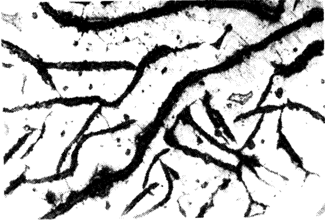
Rys. 6.9. Mikrostruktura żeliwa szarego ferrytycznego. Na tle ferrytu widoczne płatkowe wydzielenia grafitu. Trawiono 3% nitaliem. Pow. 100x
