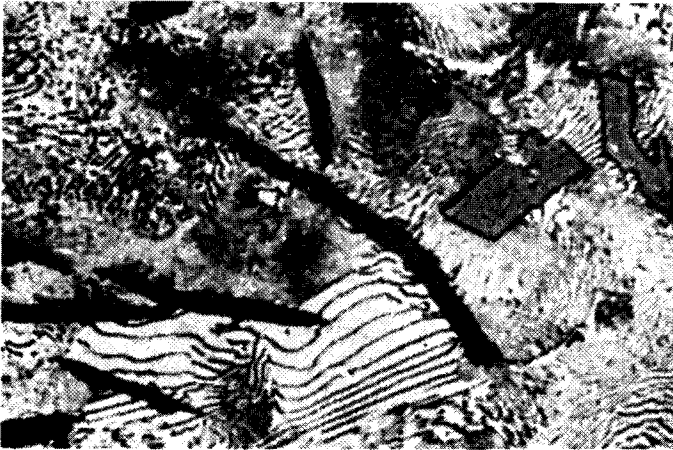
Rys. 6.10. Mikrostruktura żeliwa szarego perlitycznego. Na tle perlitu widoczne czarne płatkowe wydzielenia grafitu. Trawiono 3% nitaliem. Pow. 200x
