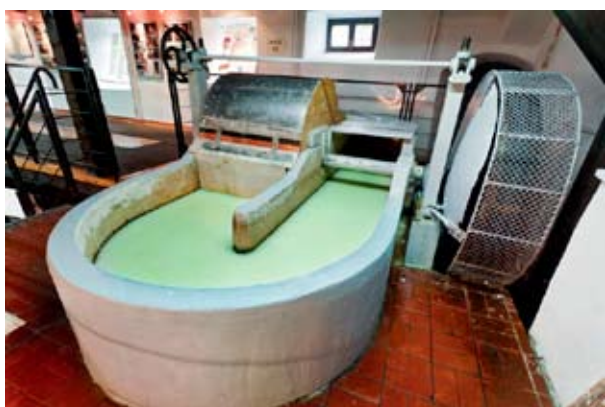
Fot. 54. Urządzenia czerpalni – holender. Fot. A. Fortuna-Marek
