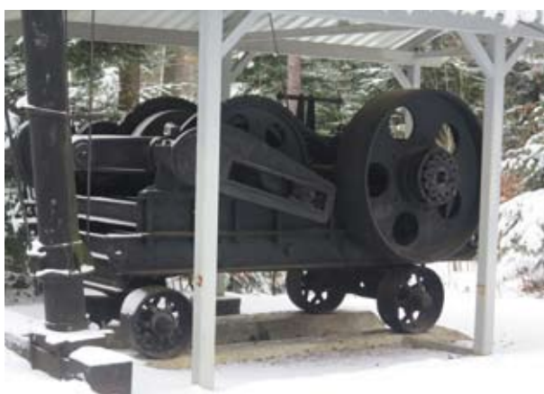
Fot. 58 Kocioł parowy przewoźny z 1912 r., fot. A. Siwek
