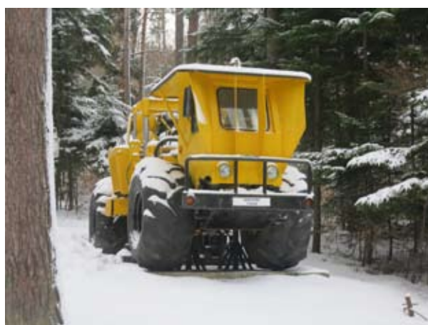
Fot. 59 Pojazd do rozbudzania drgań sejsmicznych, fot. A. Siwek
