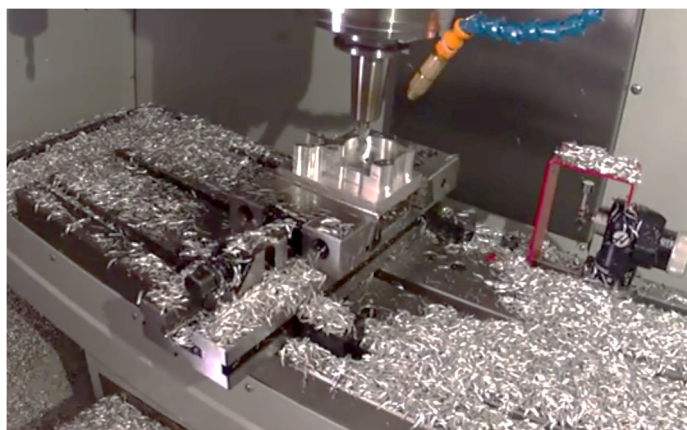
Rys. 2. 11. Przykład obróbki na sucho stopu magnezu AZ31B [126]
