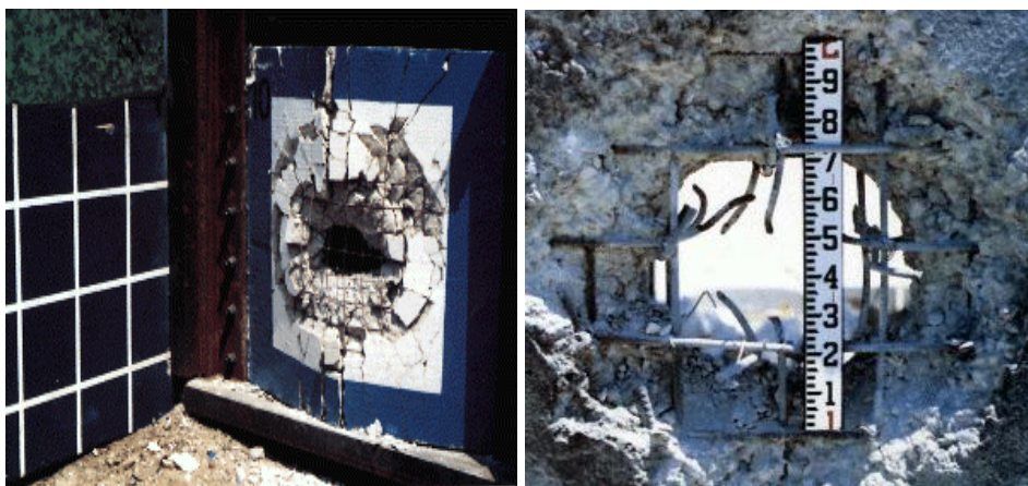
Рис. 2.14. Исследование бетонной плиты при использовании взрывчатых веществ [316]: а – вид пластины, помещенной в специальной камере, б – фрагмент разрушения
