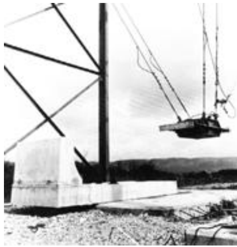
Рис. 2.5. Вид испытательной установки для измерения устойчивости на удар сборных железобетонных элементов моста [312]: а – вид баллистического молота в натуральном масштабе, б – испытание сборного железобетонного элемента барьера моста
