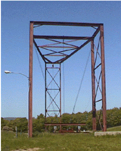
Рис. 2.5. Вид испытательной установки для измерения устойчивости на удар сборных железобетонных элементов моста [312]: а – вид баллистического молота в натуральном масштабе, б – испытание сборного железобетонного элемента барьера моста
