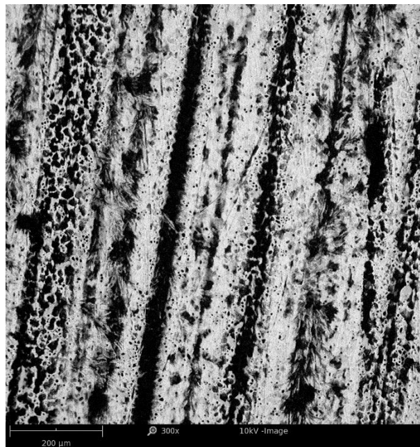
Rys. 11. Obraz SEM śladu zużycia stopu COLMONOY 237
