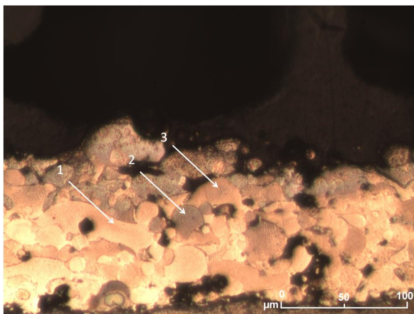
Rys. 13. Powłoka natryskiwana Deloro 50, struktura trawiona wodą królewską
