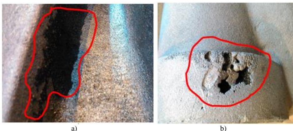
Rys. 13. Przykładowe wady powierzchniowe: a) przywarcia masy formierskiej do powierzchni surowej odlewu, b) zaprószenie masą formierską powierzchni surowej odlewu
