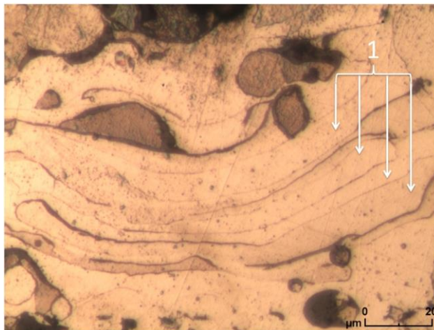
Rys. 11. Powłoka natryskiwana AMI 3602. Widoczne lamele (1). Materiał trawiony wodą królewską
