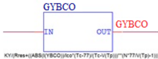
Rys. 7. Blok napięciowy ABM obliczający konduktancję warstwy nadprzewodnika YBCO
