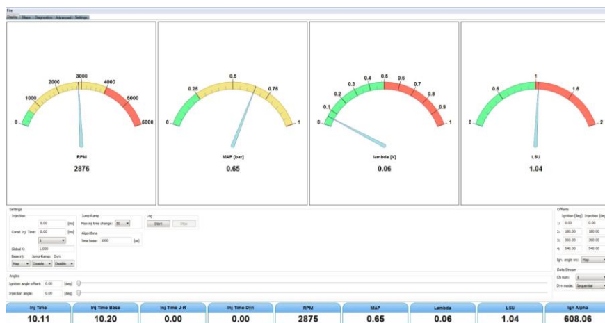
Rys. 4.4. Interfejs użytkownika oprogramowania sterującego USS-02
