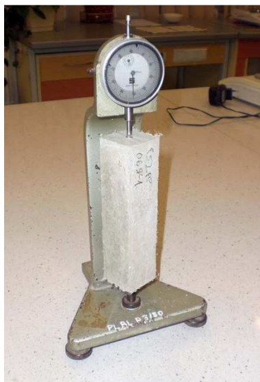
Rys. 4.8. Stanowisko badawcze do oznaczania skurczu liniowego próbek zaczynu cementowego [M. Szelağ]
