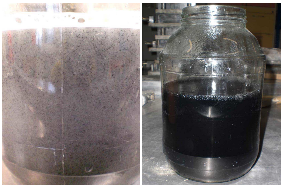
Rys. 4.4. Wodna dyspersja CNT: przed sonifikacją (po lewej) – widoczne gołym okiem skupiska nanorurek w postaci „grudek”; po sonifikacji (po prawej) – jednolity kolor dyspersji świadczący o równomiernym rozproszeniu CNT [M. Szelał]
