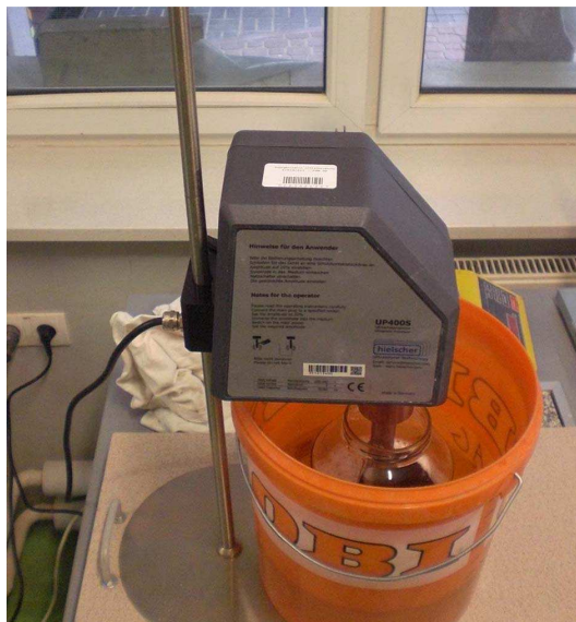
Rys. 4.3. Stanowisko laboratoryjne do wykonywania wodnej dyspersji nanorurek węglowych [M. Szelał]
