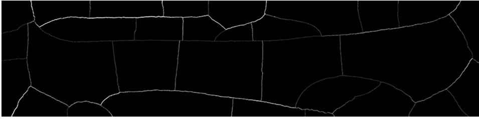
Rys. 4.12. Obraz zeskanowanej powierzchni próbki przygotowany do wykonania pomiaru \bar{A} i \bar{L} [opracowanie własne]
