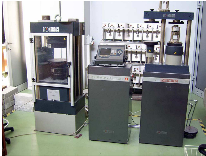
Rys. 4.7. Stanowisko badawcze do badania wytrzymałości na ściskanie [M. Szląg]
