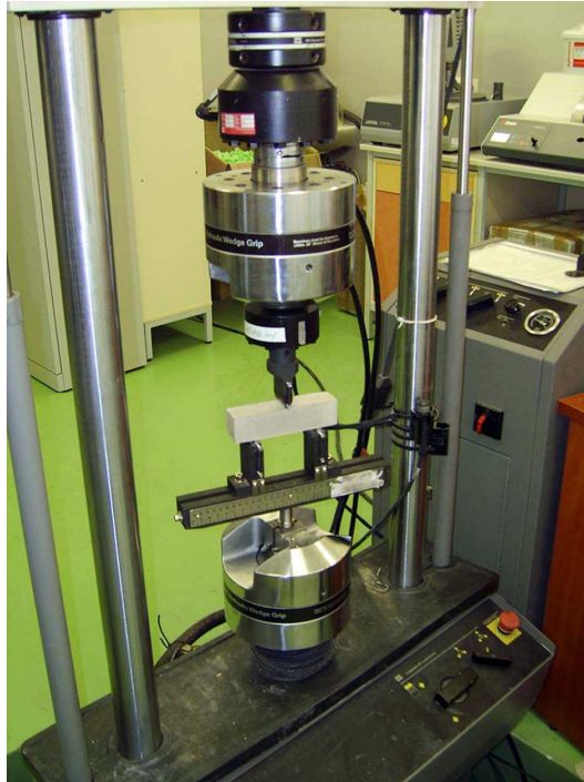
Rys. 4.6. Stanowisko badawcze do badania wytrzymałości na rozciąganie przy zginaniu [M. Szeląg]
