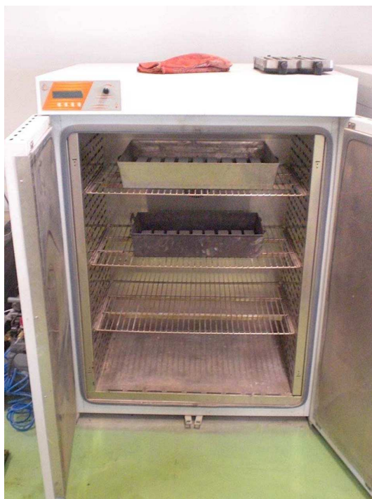
Rys. 4.5. Stanowisko laboratoryjne do obciążania próbek temperaturą [M. Szeląg]
