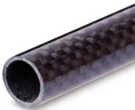
Rys. 5.8 Rura karbonowa z widocznymi warstwami włókien [8]
