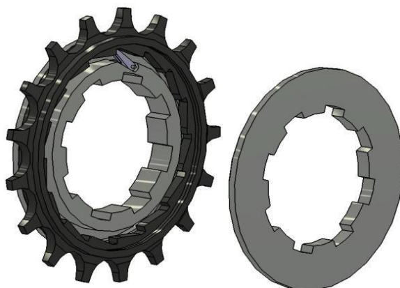
Rys. 5.15 Tylna zębatka o liczbie zębów z = 17 (tzw. wolnobieg)
