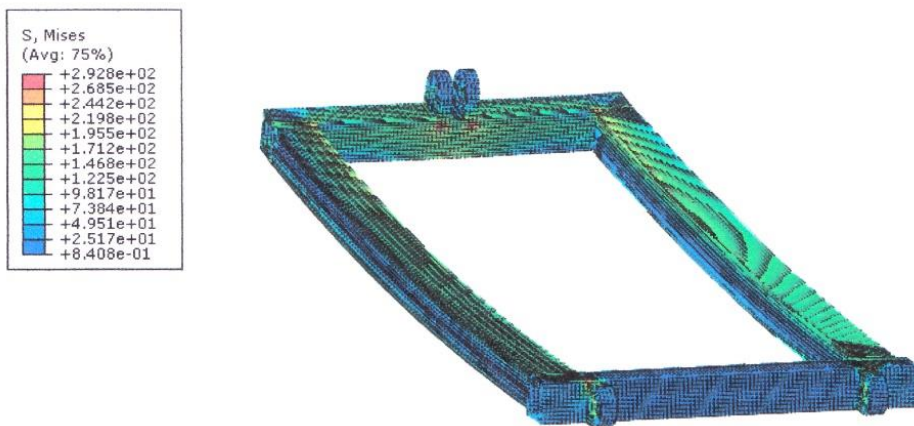
Rys. 3.19 Model ramienia dźwigni z polami naprężeń zredukowanych
