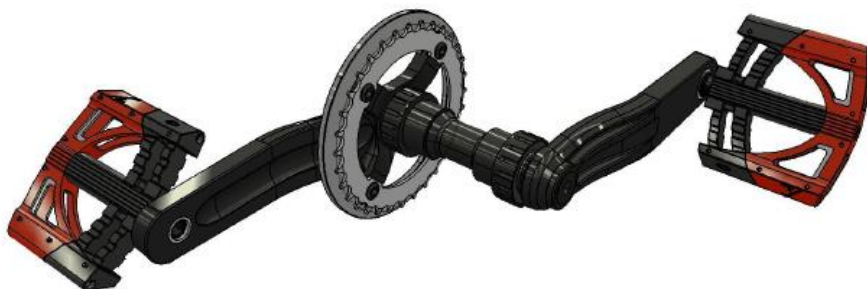
Rys. 5.13 Korba, duże koło zębate i pedały
