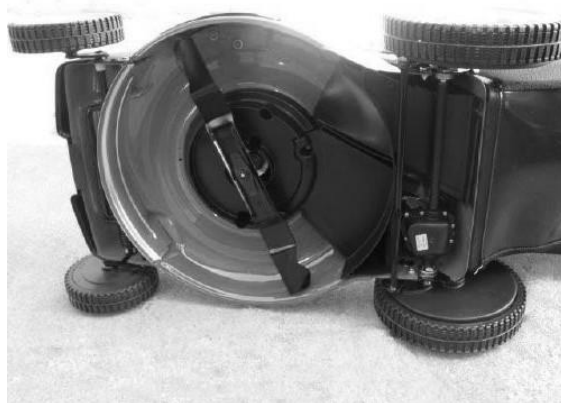
Rys. 2.1 Widok kosiarki rotacyjnej od strony noża tnącego
