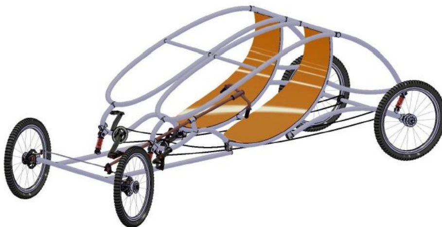
Rys. 5.9 Model 3D roweru poziomego
