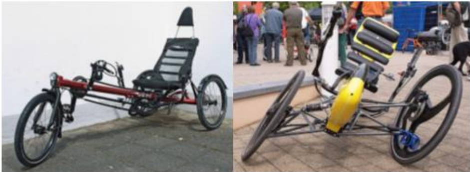
Rys. 5.7 Rowery trójkołowe [1]: a – Delta trike, b – Leaning trike
