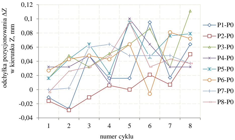
Rys. 7.9. Wartość odchyłki pozycjonowania \Delta Z mierzona w kierunku Z, przy osiągnięciu pozycji nominalnej P0 z wybranych kierunków dojazdu, w kolejnych cyklach pomiarowych
