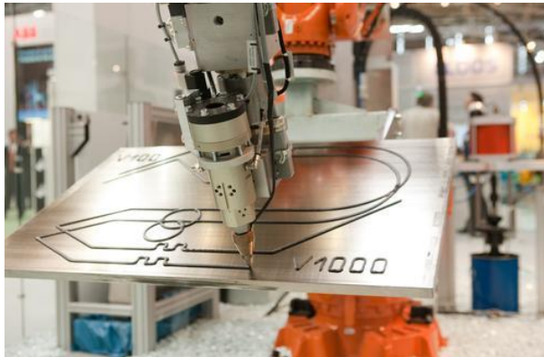
Rys. 2.14. Zastosowanie robotów przemysłowych w operacjach klejenia [77]
