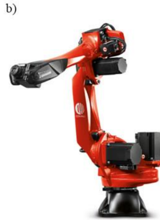
Rys. 2.6. Robot o strukturze przegubowej: a) struktura kinematyczna [17], b) widok ogólny robota Comau Racer [70]
