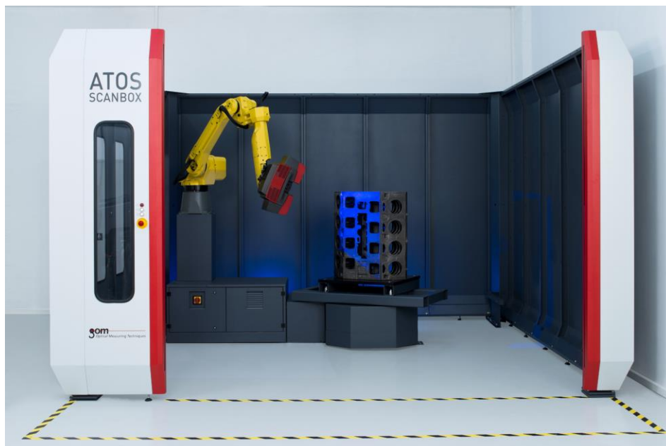
Rys. 2.18. Zastosowanie robota przemysłowego do pomiarów współrzędnościowych 3D systemem ATOS ScanBox [82]
