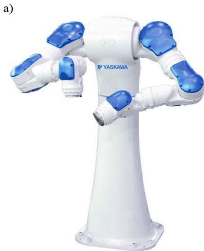
Rys. 2.7. Roboty wieloramienne: a) robot firmy Yaskawa z serii SDA [79], b) robot firmy Yushin, [68], c) robot STAR Es-800s [69]
