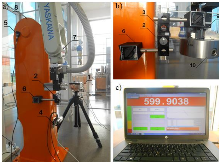
Rys. 5.2. Konfiguracja pomiarowa rozmieszczenia elementów systemu laserowego podczas: a) próby bez obciążenia, b) próby z obciążeniem, c) konfigurowanie toru pomiarowego z poziomu oprogramowania LaserXL, 1 – generator lasera, 2 – interferometr liniowy z reflektorem odniesienia, 3 – reflektor ruchomy, 4 – kompensator XC-80, 5 – czujnik parametrów środowiskowych, 6 – uchwyt magnetyczny, 7 – ramię robota, 8 – filar, 9 – chwytak robota, 10 – obciążenie
