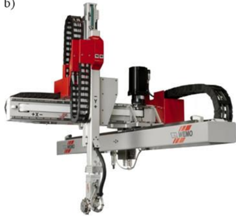
Rys. 2.2. Robot o układzie kartezjańskim: a) struktura kinematyczna [17], b) widok ogólny robota WEMO 16-HS [64]
