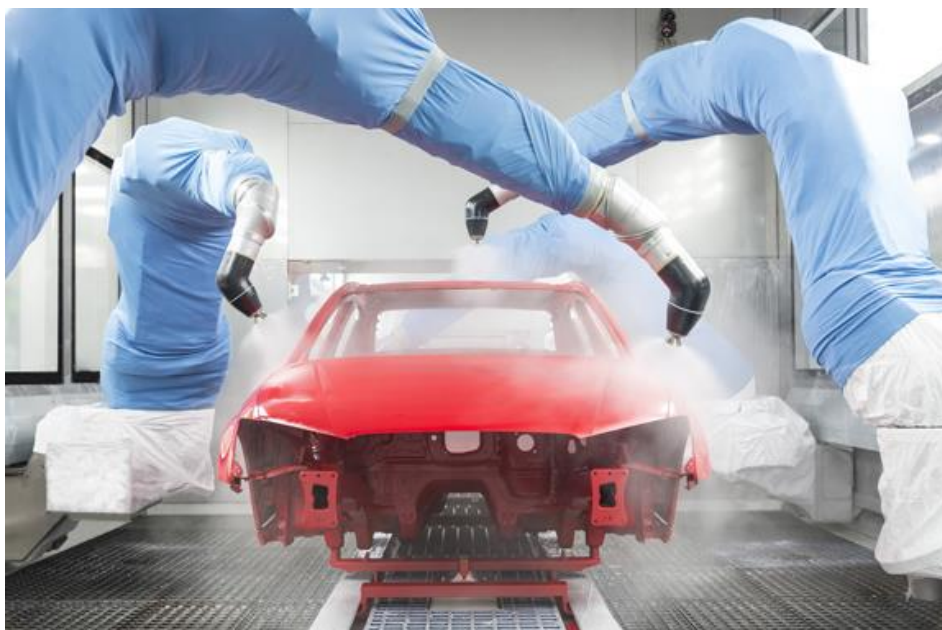
Rys. 2.17. Zrobotyzowane stanowisko lakierowania karoserii samochodu [81]
