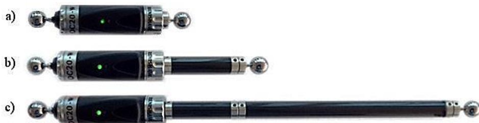
Rys. 6.2. Długości teleskopowego pręta kinematycznego zastosowane w teście kołowości: a) r = 100 mm, b) r = 150 mm, c) r = 300 mm
