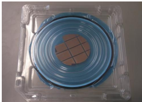
Rys. 4. Krzemowa płytka pokryta metalizacją miedzi
