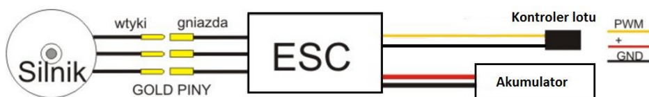
Rys. 9 Realizacja połączenia modułu ESC z wbudowanym BEC
