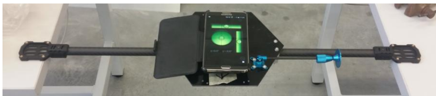
Rys. 5. Poziomowanie ramion względem płyty centralnego
