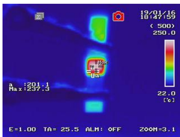
Rys. 10. Typowy rozkład temperatury na mikrogrzejniku z NiCr
