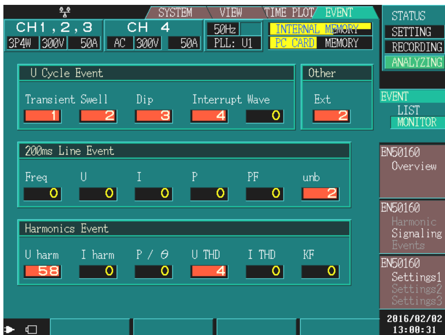
Rys. 5. Hioki 3196 – rejestr zdarzeń (źródło: opracowanie własne)
