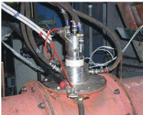
Rys. 4. Plazmotron na pyłoprzewodzie palnika rozruchowego [2]
