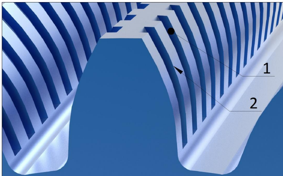
Rys. 10.9. Ząb wiórkownika: 1 – rowek, 2 – krawędź
