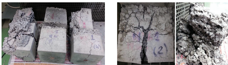
Rys. 5.22. Zniszczenie próbek betonu po 28 cyklu badania mrozoodporności
