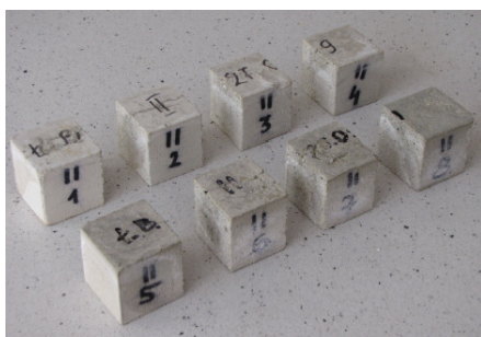
Rys. 5.35. Stan próbek zaprawy z perlitem po badaniu odporności na krystalizację soli: a) zhydrofobizowane w masie (DC), b) zhydrofobizowane powierzchniowo wodnym preparatem KK
