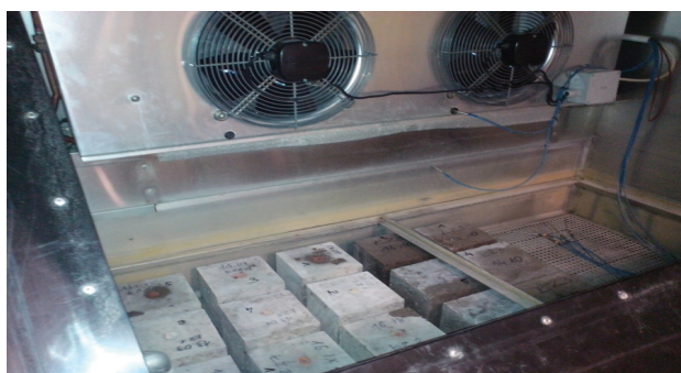
Rys. 5.23. Próbkki betonu zwykłego w urządzeniu do badania mrozoodporności (stan po 50 cyklu)
