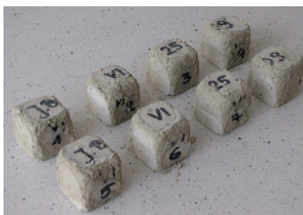
Rys. 5.35. Stan próbek zaprawy z perlitem po badaniu odporności na krystalizację soli: a) zhydrofobizowane w masie (DC), b) zhydrofobizowane powierzchniowo wodnym preparatem KK
