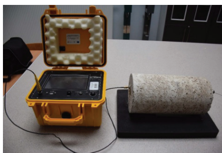
Rys. 5.27. Badanie dynamicznego modułu sprężystości betonu zwykłego BZ1
