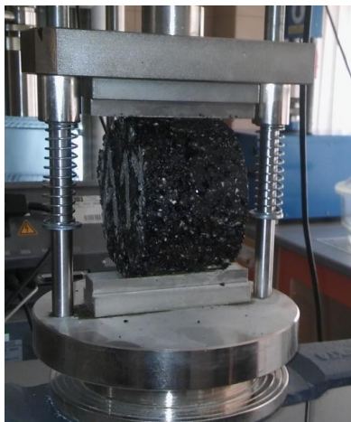
Fot. 4.4. Próbką umieszczona w uchwycie prasy Marshalla podczas badania wytrzymałości na pośrednie rozciąganie
