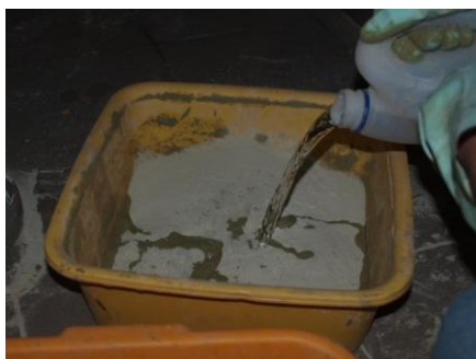
Fot. 6.1. Nasączenie zeolitu naturalnego klinoptilolitu wodą
