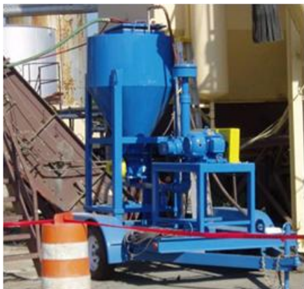
Rys. 2.7. Ruchomy zasobnik dozowania zeolitu [194]
