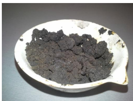
Fot. 5.4. Próba przygotowania próbki wg normy PN-EN 13179-1:2013 [184] do badania właściwości usztywniających zeolitu syntetycznego typu NaP1
