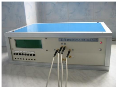
Rys.2.2.4. Miernik laboratoryjny TDR Multimeter MTS-1 (LOM) stosowany w badaniach, pełniący funkcję generatora i odbiornika impulsów (źródło: fotografia własna)
