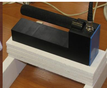
Rysunek 3.2.2. Eksperyment wyznaczania zasięgu oddziaływania pola sondy powierzchniowej TDR B2
