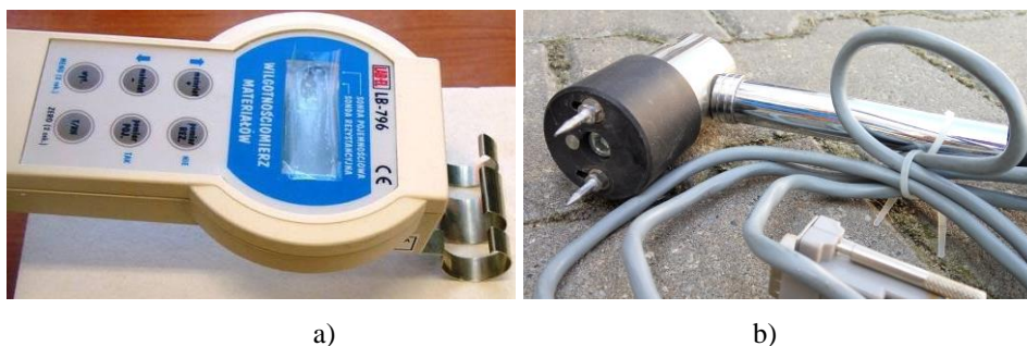
Rys. 2.2.1. Miernik wilgotności materiałów budowlanych (Producent LABEL, Polska) działający na zasadzie techniki pojemnościowej FD (a), sonda młotkowa wykorzystywana w technice rezystancyjnej (elektrooporowej) (b) (źródło: fot. własne autora)
