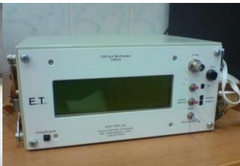
Rys. 2.2.5. Miernik przenośny (FOM) (ETest, Lublin) stosowany w badaniach terenowych (źródło: fotografia własna)
