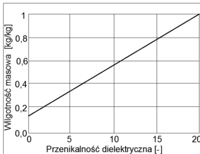
Rys. 2.2.21. Kalibracja sondy TDR do pomiarów wilgotności betonu komórkowego (opracowanie własne na podst. Hansen, 2002a)
