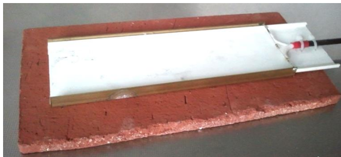
Rys. 3.1.14 Fotografia sondy powierzchniowej C
