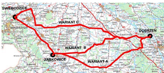
Rys. 1. Rozpatrywane warianty trasy linii 400 kV na odcinku Świebodzice – Dobrzeń. Rekomendowana trasa – B [14]
