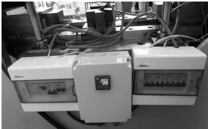
Rys. 5.13. Układ sterujący systemu grzewczego wykorzystany do badań
