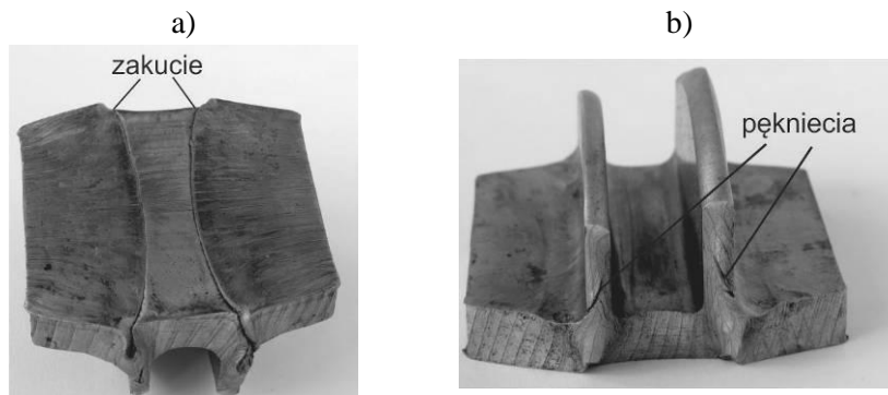
Rys. 5.28. Przykładowe odkuwki dwużebrowe z zakuciem w podstawie (a) oraz z pęknięciami i nierównomiernością wysokości i grubości żeber (b)
