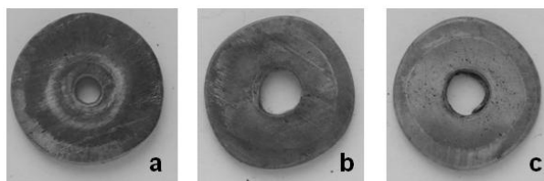
Rys. 3.21. Spęćzone próbki ze stopu magnezu AZ31 nagrzane do temperatury 350°C: a) bez smarowania, b) ze smarowaniem dwusiarczkiem molibdenu, c) ze smarowaniem łożem z grafitem
