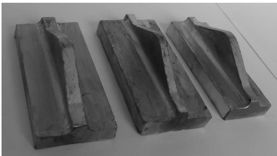
Rys. 5.16. Odkuwki z jednym źebrem o zarysie trójkątym ze stopu AZ31 uzyskane w procesie kształtowania w wykroju zamkniętym w TPK
