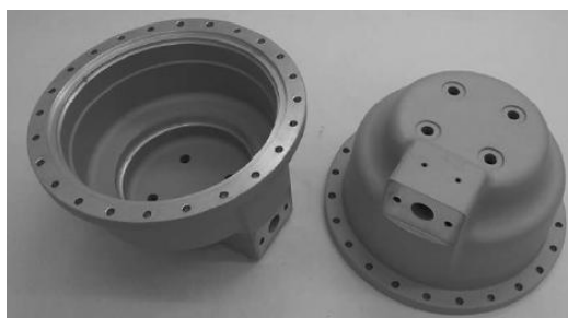
Rys. 2.52. Odkuwka obudowy sprężarki dla systemu klimatyzacyjnego ze stopu magnezu WE43 [46]
