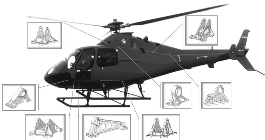
Rys. 2.2. Przykładowe wsporniki układu sterowania ze stopów magnezu wytwarzane z odlewów stosowane w budowie śmigłowców
