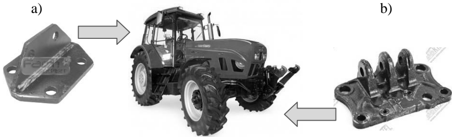
Rys. 2.9. Wsporniki ciągnika rolniczego: a) siłownika podnośnika, b) błotnika przedniego [53, 63]
