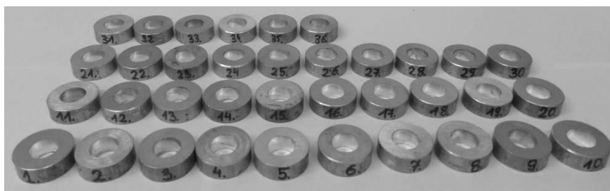
Rys. 3.16. Próbkę pierścieniowe ze stopu magnezu AZ31 przygotowane do badań warunków tarcia
