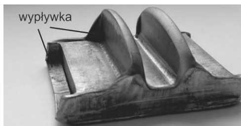
Rys. 5.30. Wypływkii na powierzchniach czołowych odkuwki z dwoma zębami
