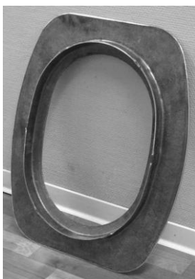
Rys. 2.45. Kształt odkuwki ramy okiennej samolotu Airbus ze stopu magnezu [45]
