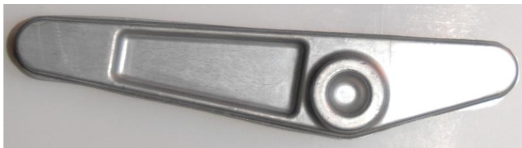
Rys. 2.54. Odkuwka dźwigni lotniczej ze stopu AZ31 [33]
