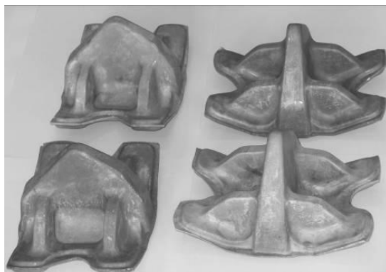
Rys. 2.13. Odkuwki uźebrowane kute matrycowo ze stopów aluminium PA31 i 2618A [101]
