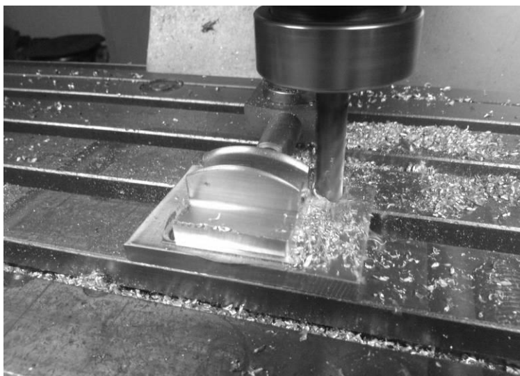
Rys. 7.5. Frezowanie odkuwki z dwoma żebrami na gotowy wspornik
