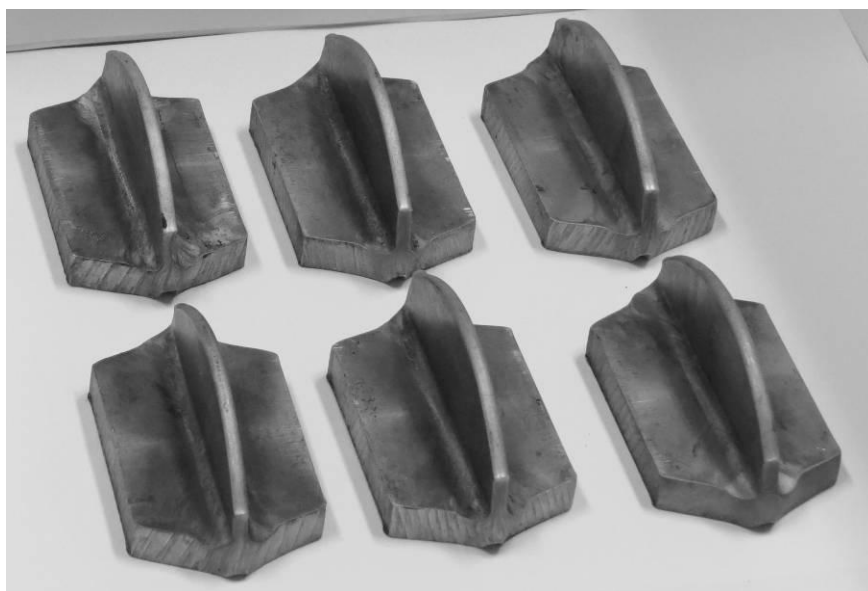
Rys. 5.14. Odkuwki z jednym żebrem ze stopu AZ31 uzyskane w procesie kształtowania półswobodnego w TPK
