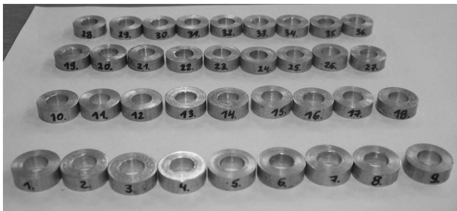
Rys. 3.15. Próbki pierścieniowe ze stopu magnezu MgAl4Zn przygotowane do badań warunków tarcia
